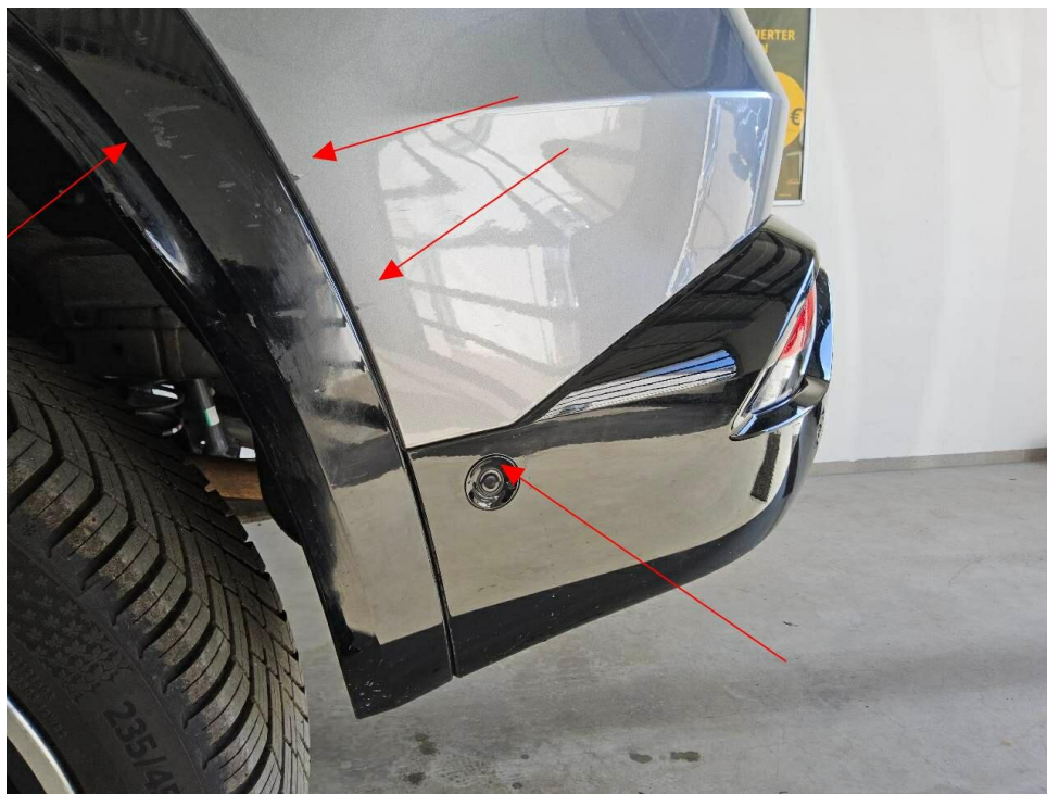
Bild 10 : Anfahrtschaden hinten links
