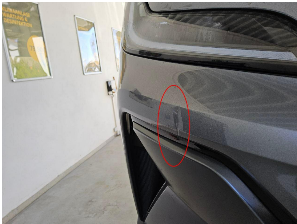
Bild 13 : Stoßfänger vorn angefahren
