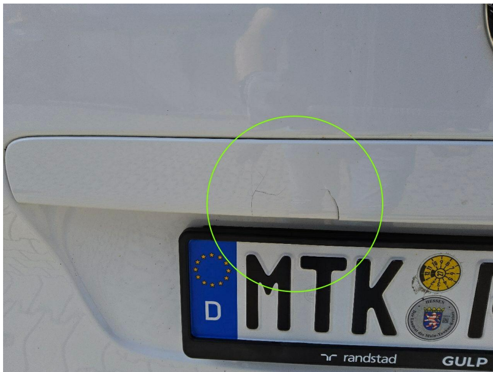
Bild 15 : Zierleiste Heckklappe gebrochen
