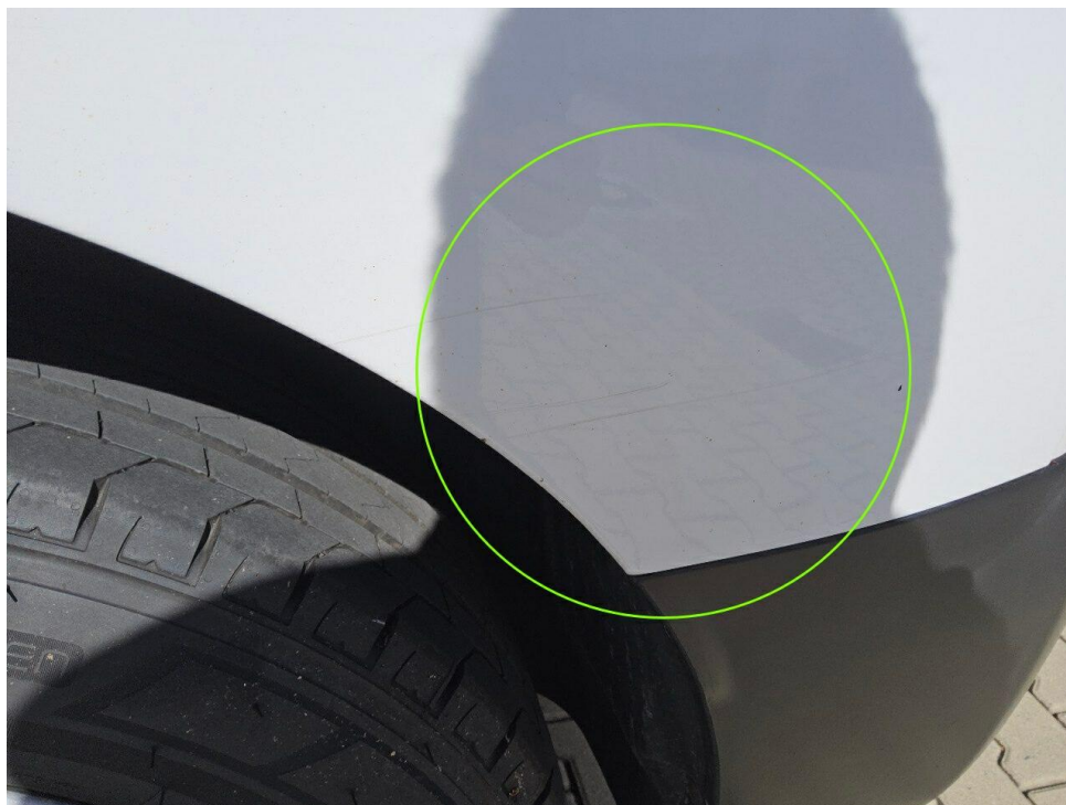
Bild 19 : Kratzer Seitenwand hinten links
