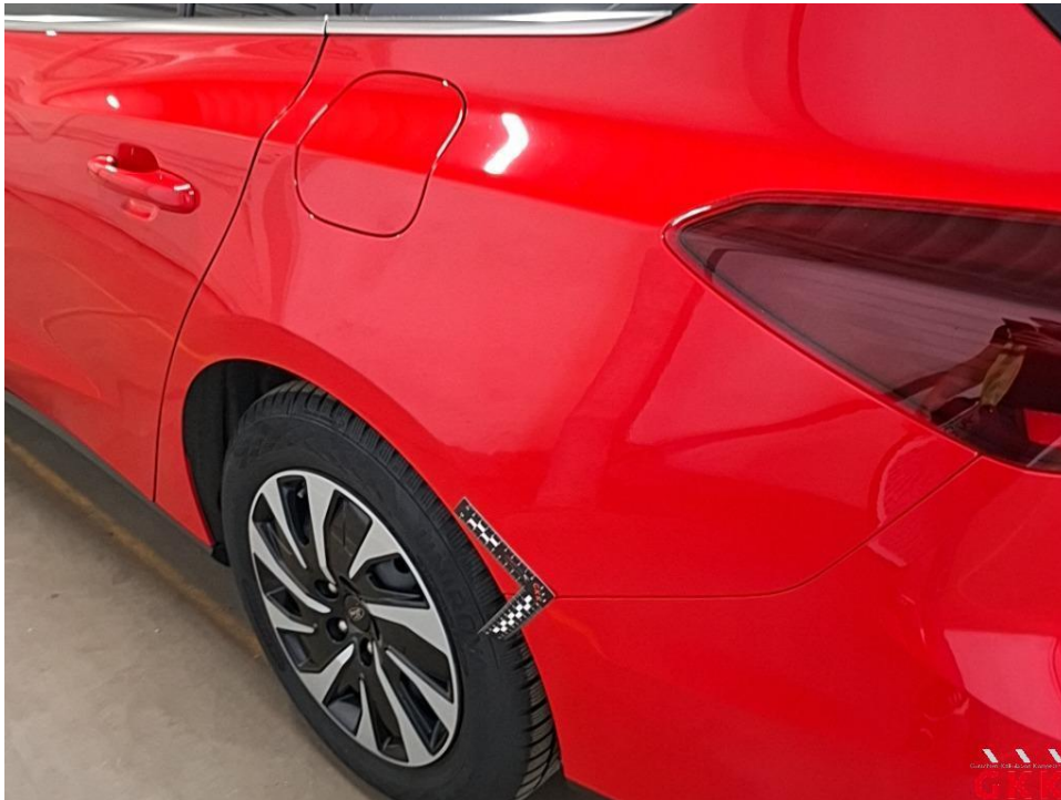
Bild 21 Seitenwand links, Reparaturmangel, lackieren
