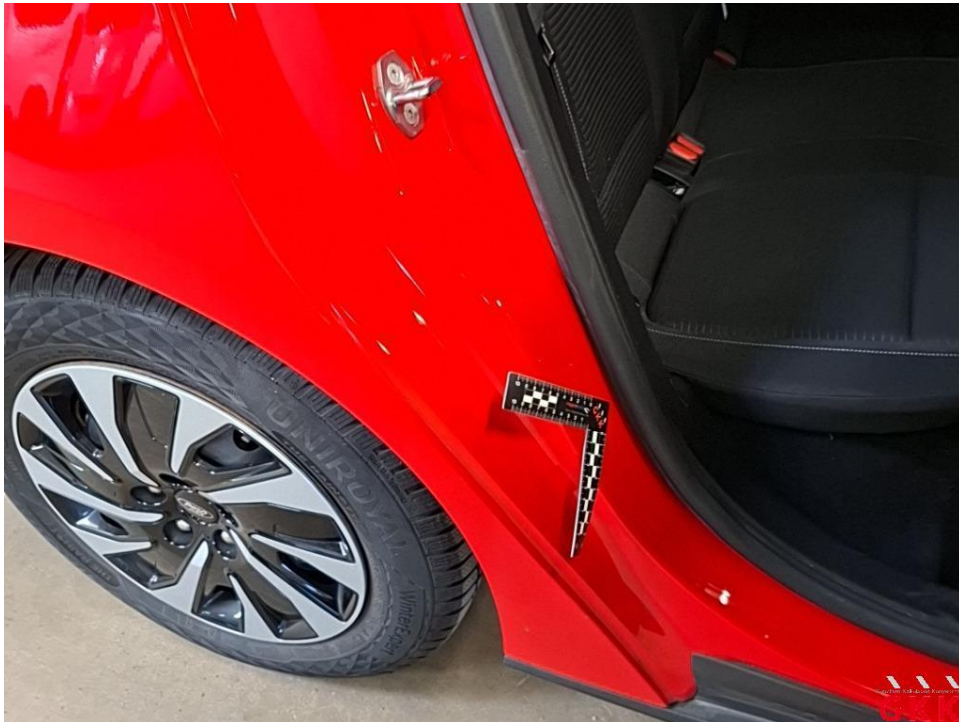
Bild 27 Tür hinten rechts, Einstieg, verkratzt, Smartrepair
