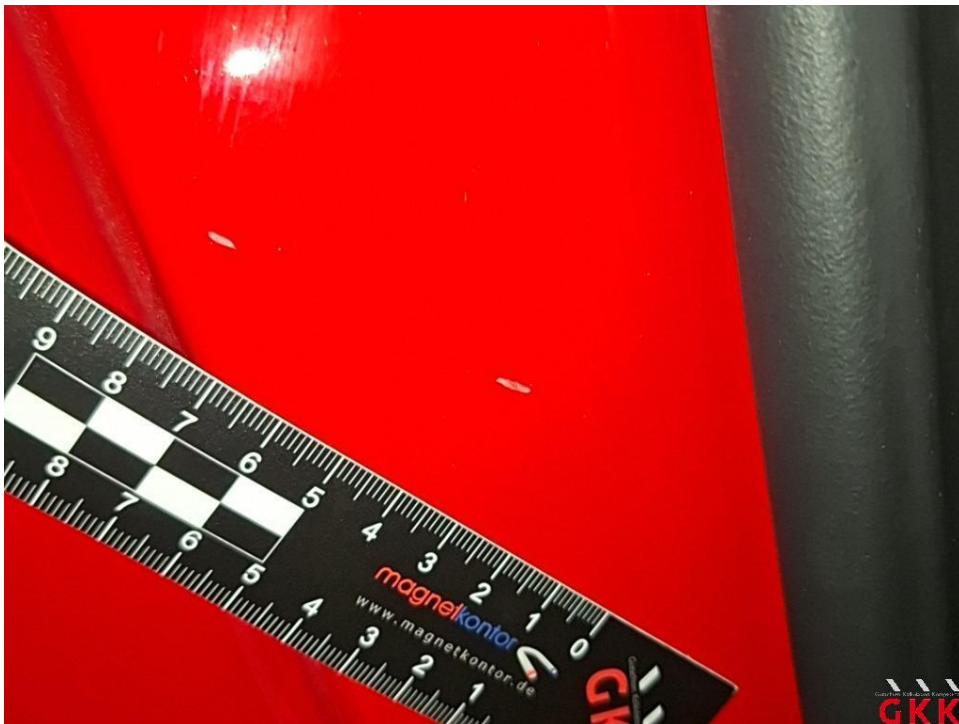
Bild 28 Tür hinten rechts, Einstieg, verkratzt, Smartrepair
