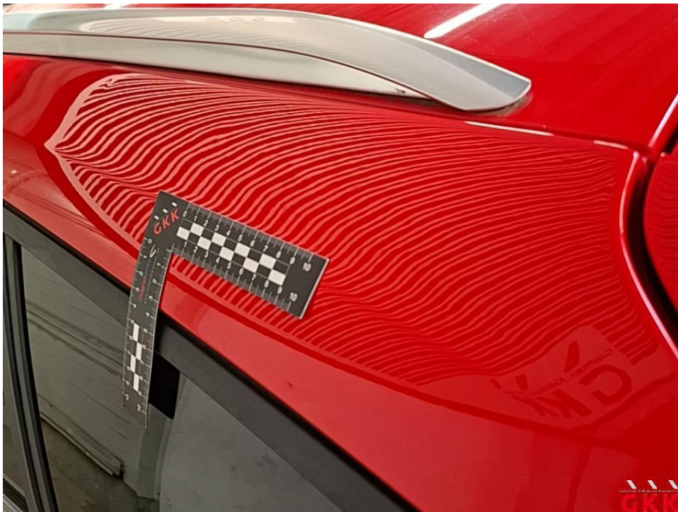
Bild 26 Dach, Holm links, Reparaturmangel, lackieren
