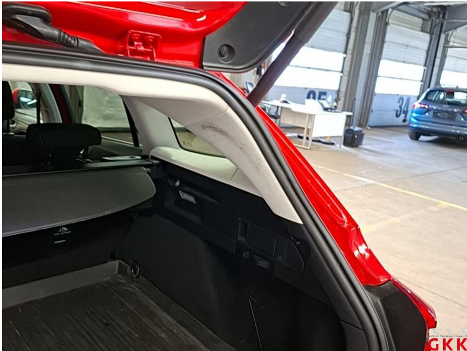
Bild 31 D- Säule rechts, Innenverkleidung, verkratzt, ersetzen
