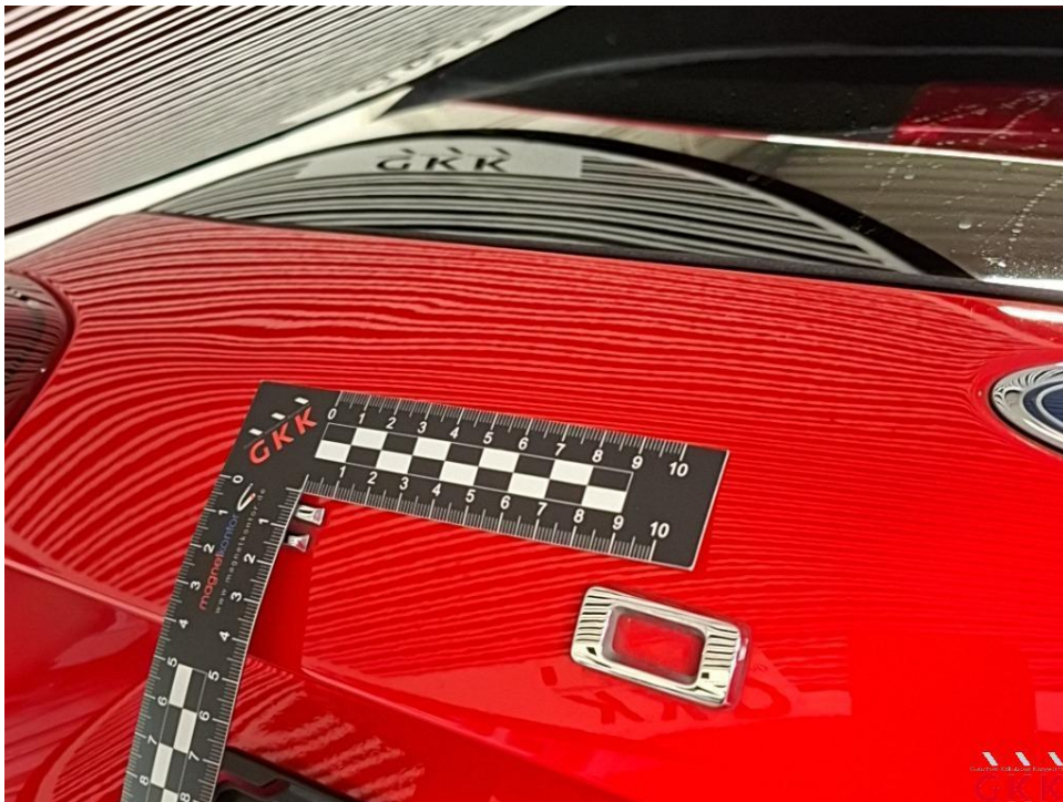
Bild 30 Heckklappe, beschädigt, instand setzen - lackieren
