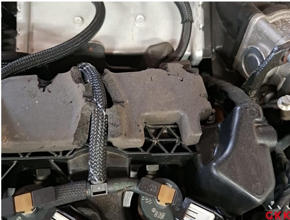
Bild 20 Motor, Abdeckung, beschädigt, ersetzen
