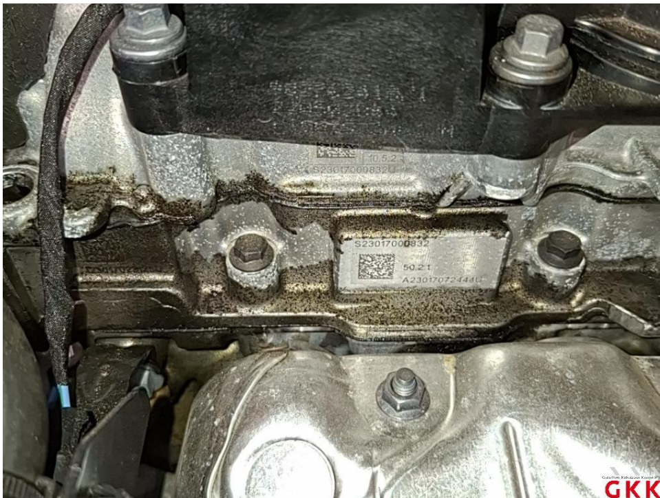
Bild 16 Motor, Öl undicht, prüfen
