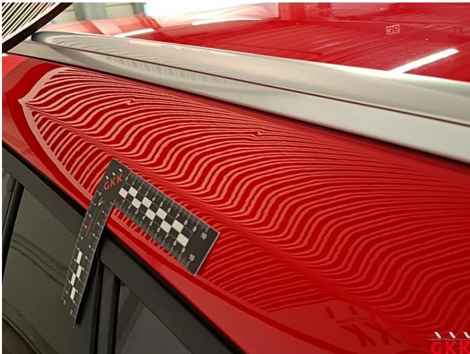
Bild 24 Dach, Holm links, beschädigt, Smartrepair
