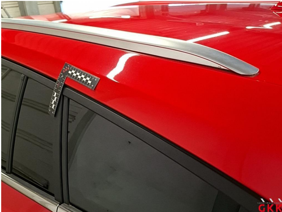
Bild 23 Dach, Holm links, beschädigt, Smartrepair
