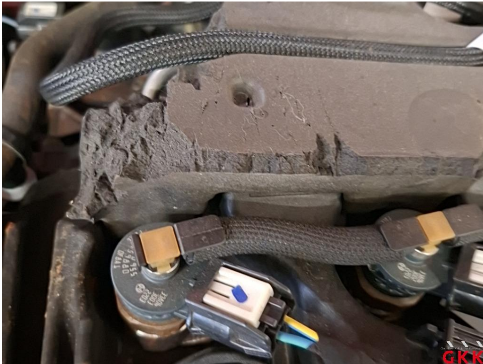
Bild 19 Motor, Abdeckung, beschädigt, ersetzen
