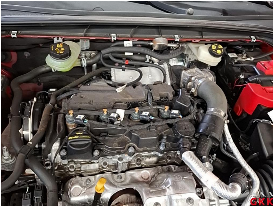
Bild 18 Motor, Abdeckung, beschädigt, ersetzen
