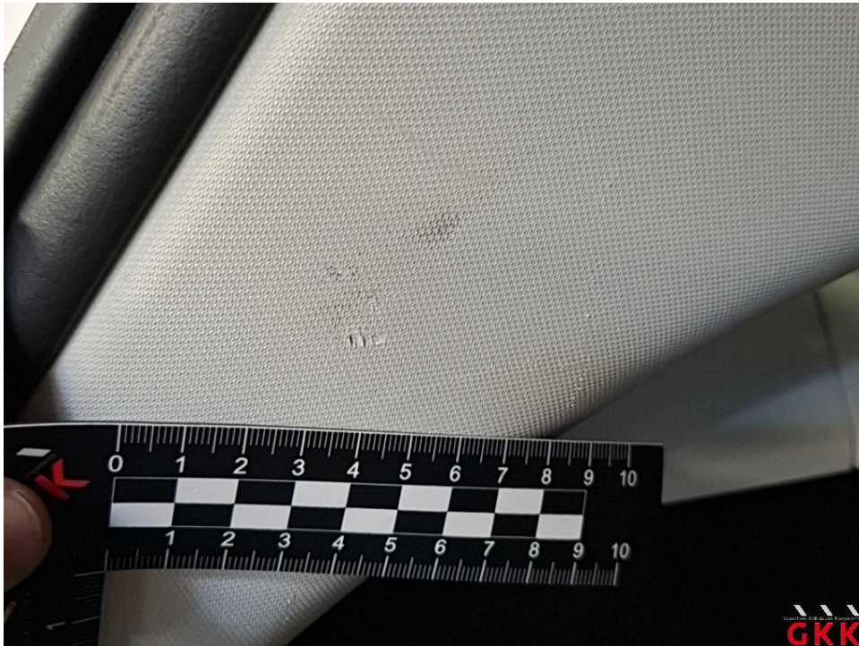
Bild 35 D- Säule links, Innenverkleidung, verkratzt, Smartrepair
