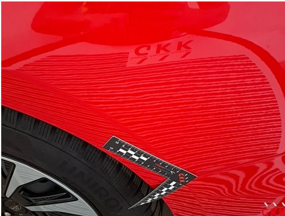
Bild 22 Seitenwand links, Reparaturmangel, lackieren
