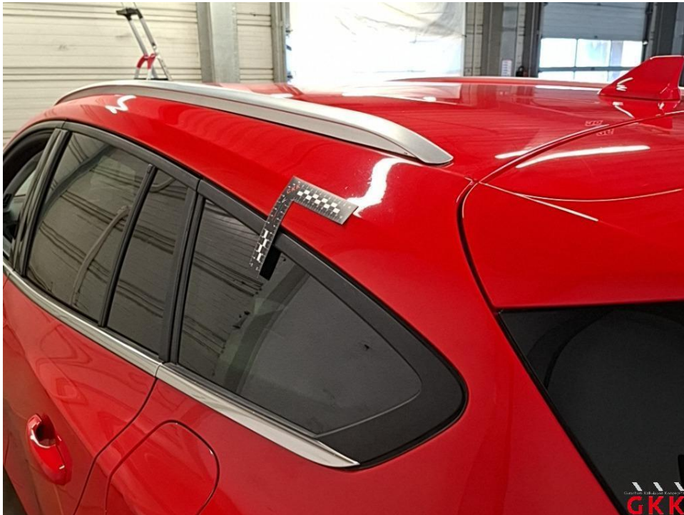
Bild 25 Dach, Holm links, Reparaturmangel, lackieren
