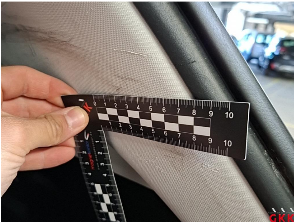
Bild 32 D- Säule rechts, Innenverkleidung, verkratzt, ersetzen
