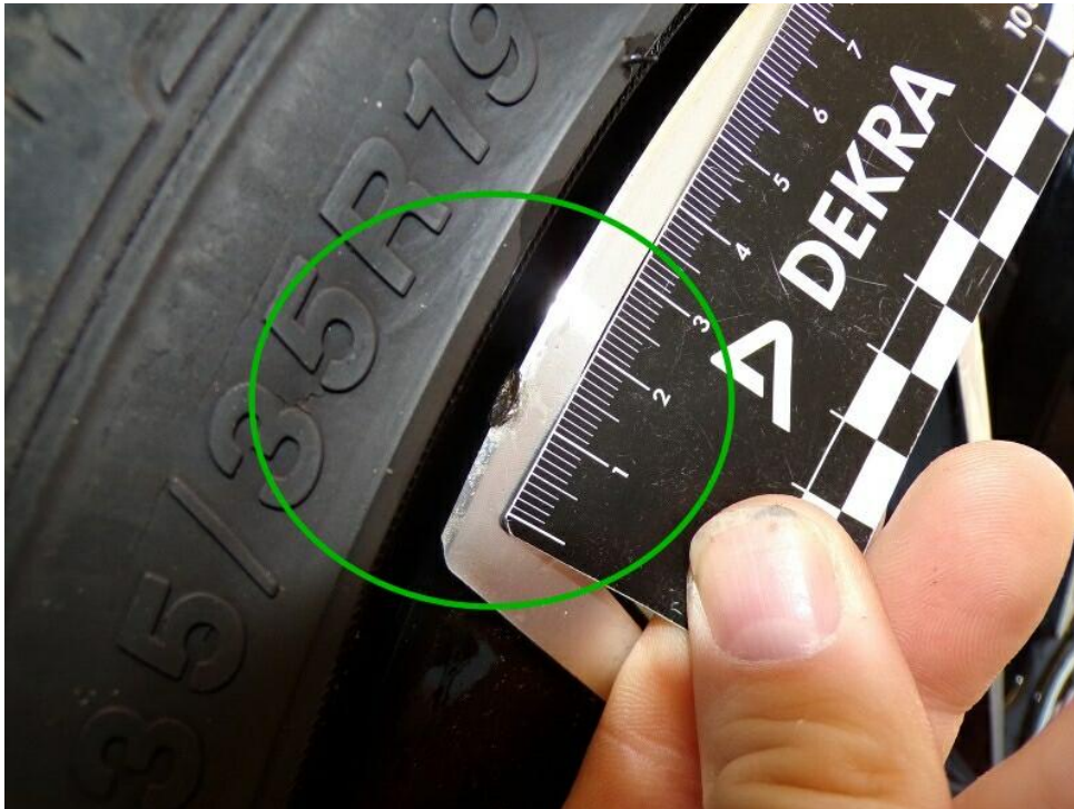
Bild 15 : Achse eins, Felge rechts Anstoß mit Materialabtrag, optische Wertminderung
