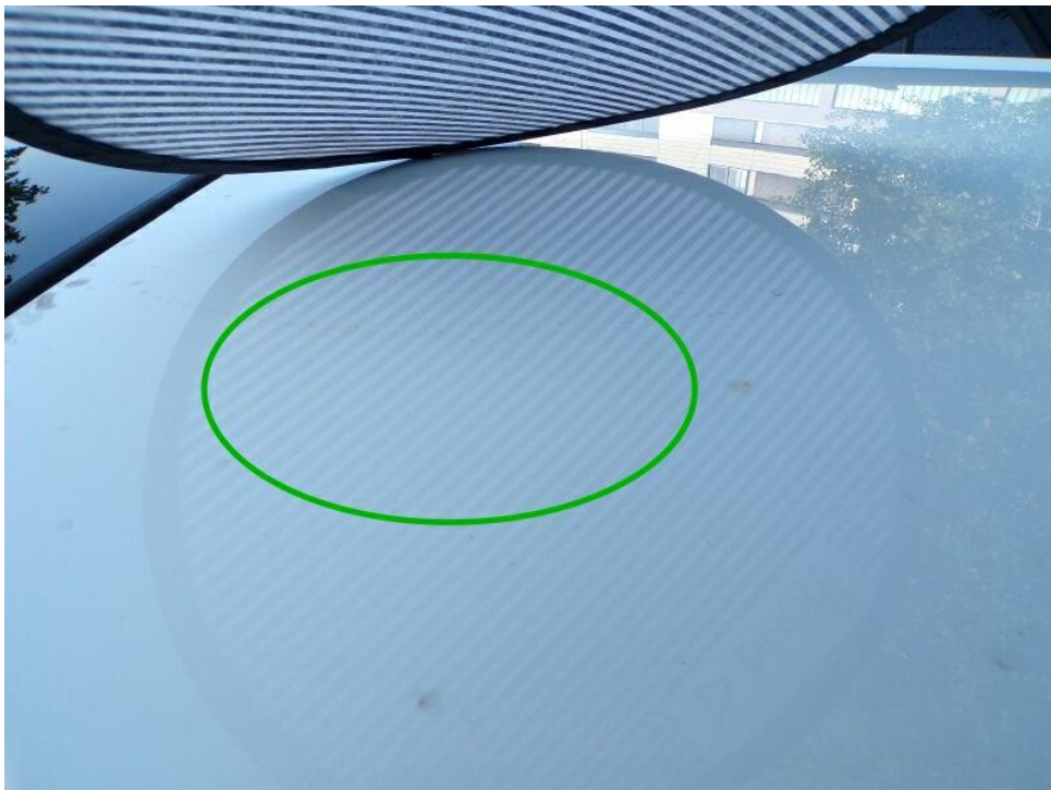
Bild 16 : Dach leicht eingedellt, Gebrauchsspur
