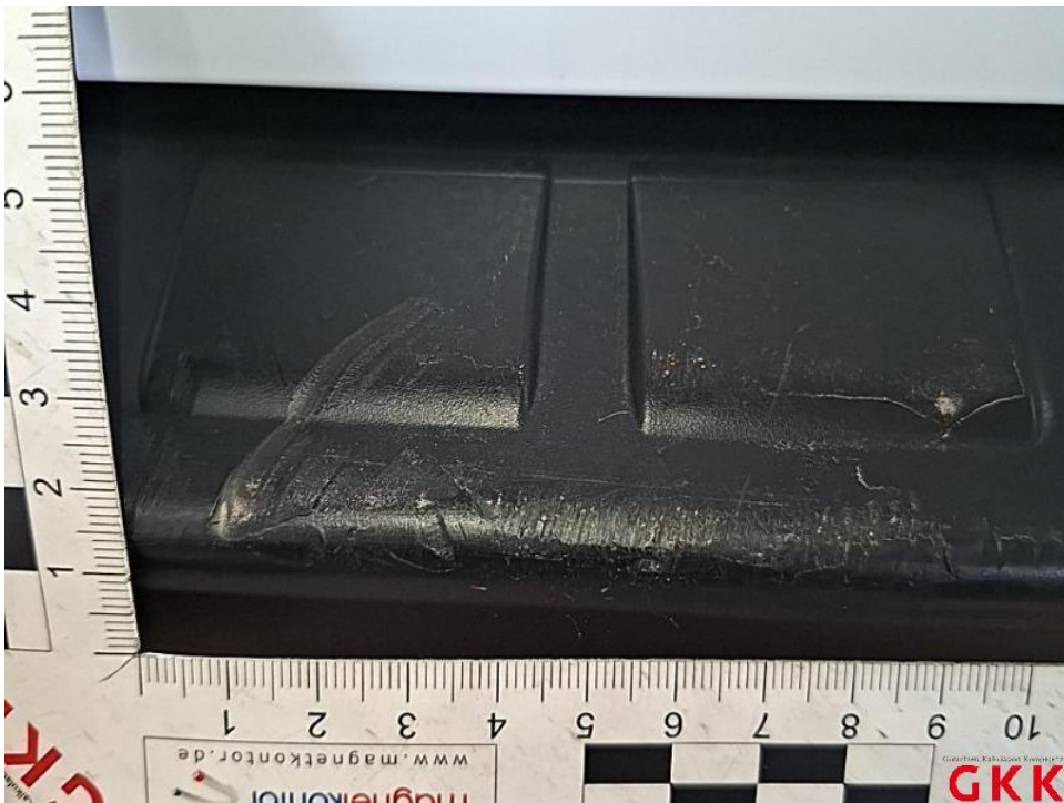
Bild 38. Stoßfänger hinten, Verkleidung -unlackiert-, beschädigt, ersetzen
