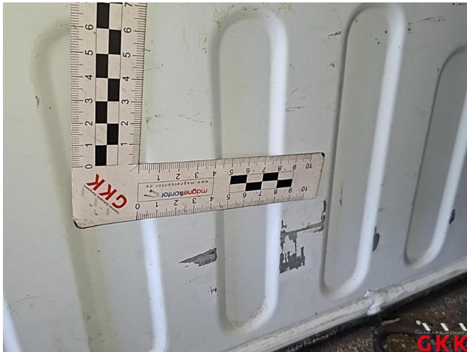
Bild 41. Radhaus hinten links, beschädigt, instand setzen - lackieren
