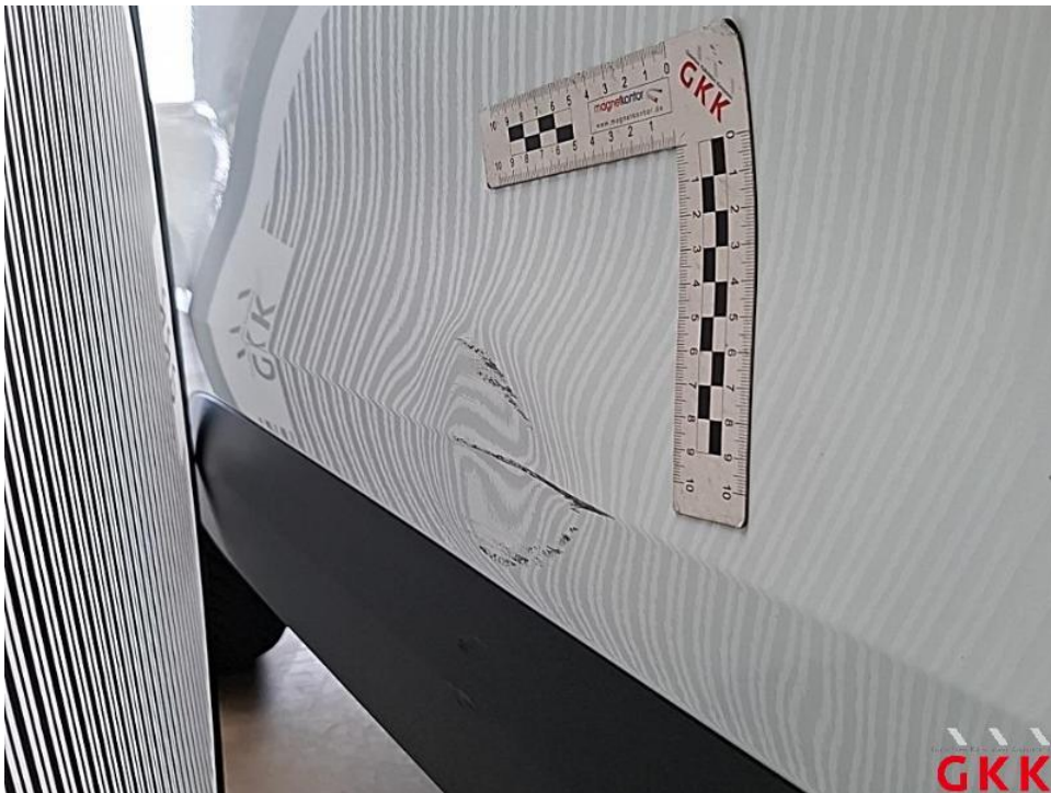
Bild 50. Schiebetür rechts, beschädigt, instand setzen - lackieren
