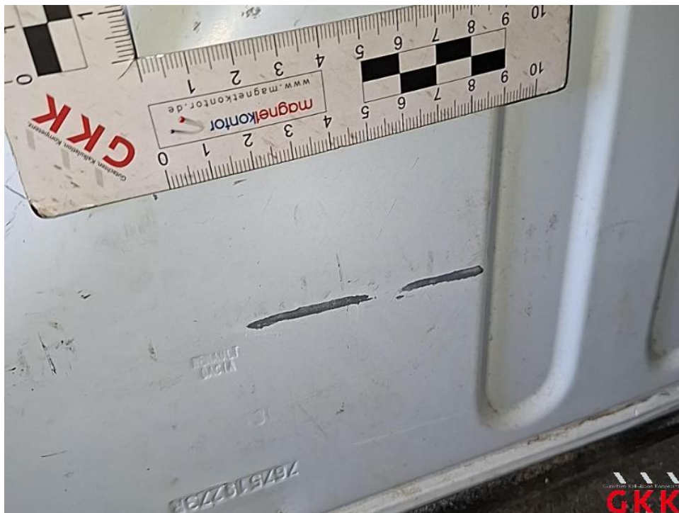
Bild 42. Radhaus hinten links, beschädigt, instand setzen - lackieren
