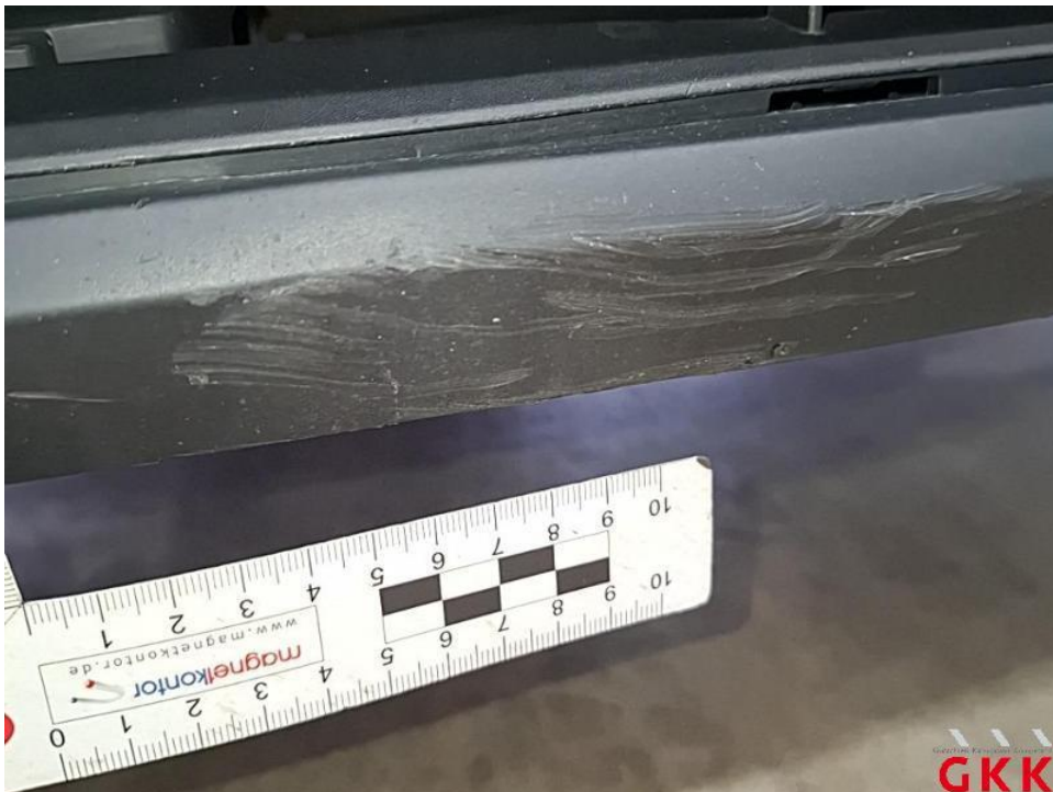
Bild 20. Stoßfänger vorne, Verkleidung -unlackiert-, beschädigt, ersetzen
