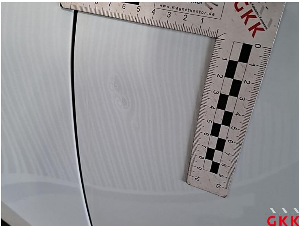
Bild 26. Tür vorne links, bis 3 Dellen / Bauteil, Smartrepair
