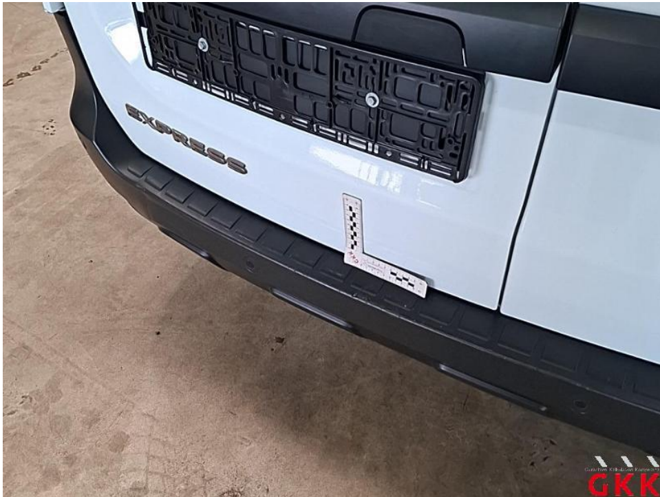
Bild 37. Stoßfänger hinten, Verkleidung -unlackiert-, beschädigt, ersetzen
