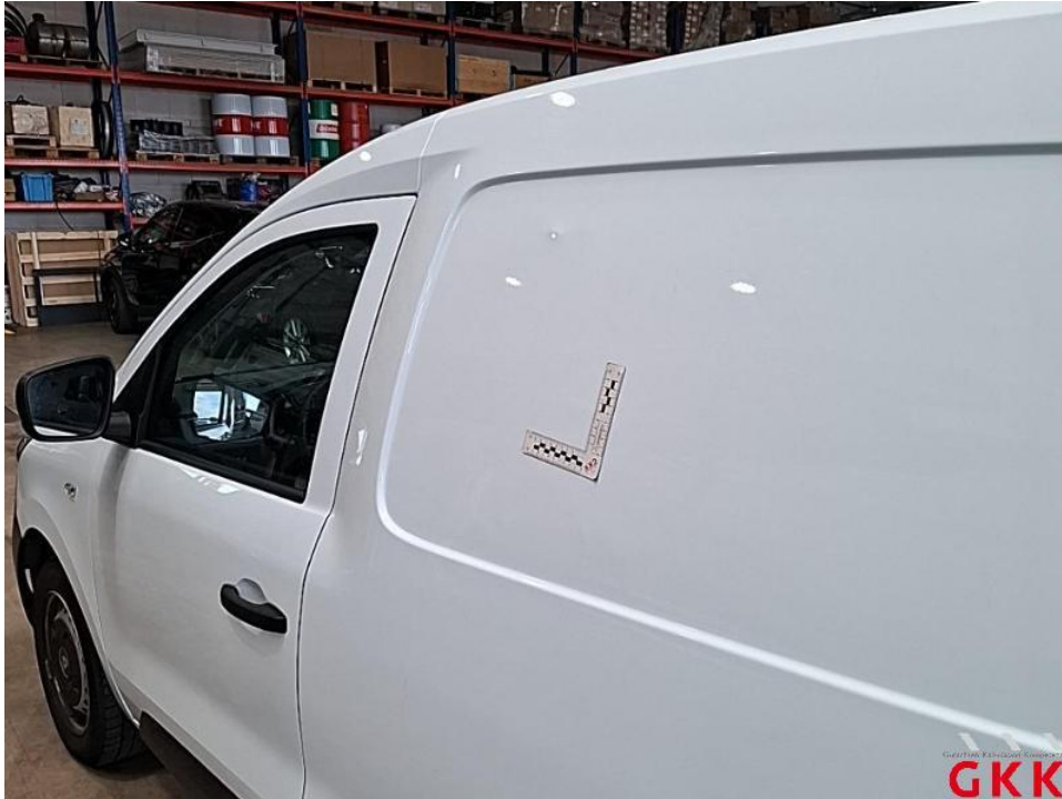
Bild 31. Seitenwand links, beschädigt, instand setzen - lackieren
