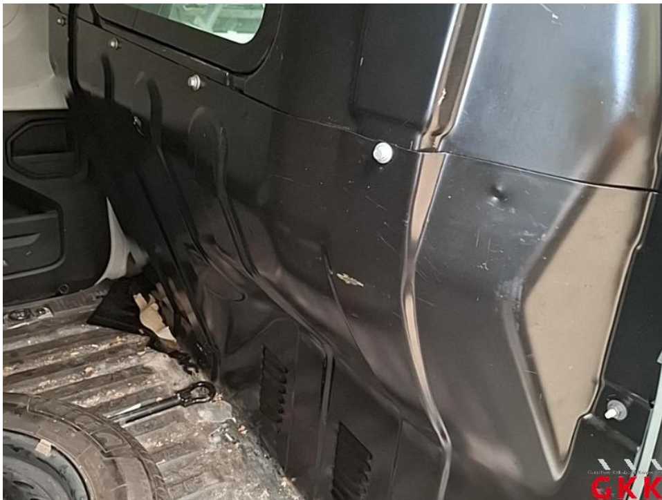
Bild 58. Trennwand, beschädigt, lackieren
