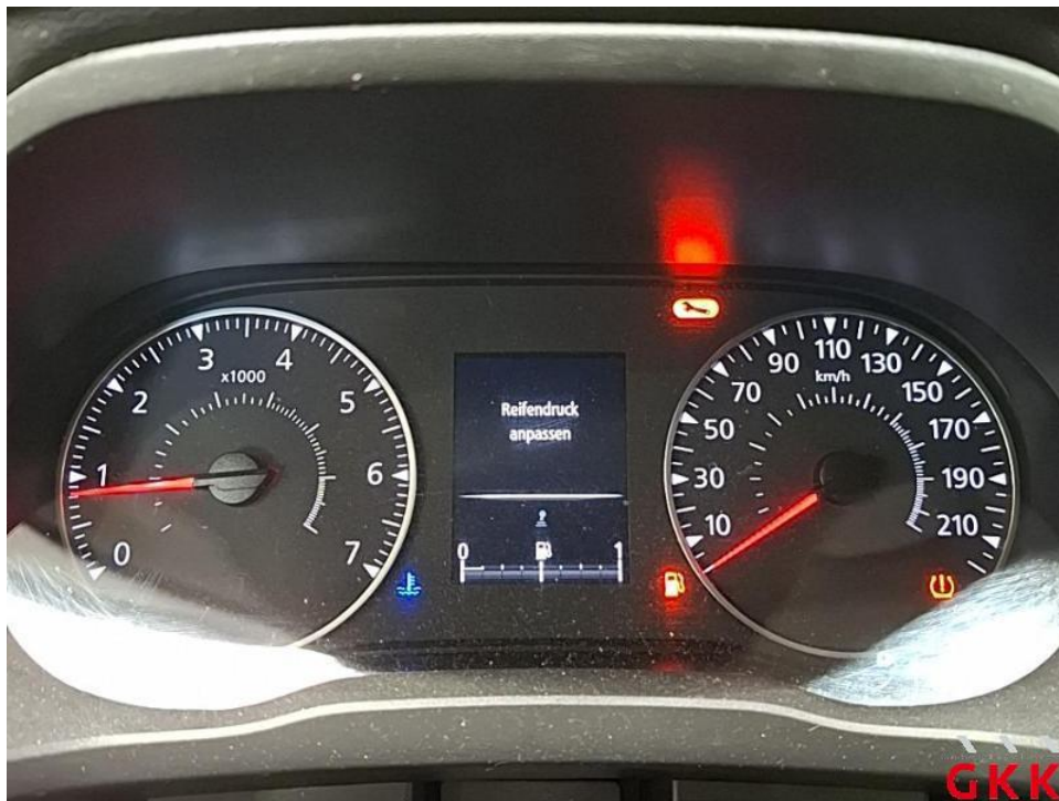
Bild 12. Kombiinstrument, Reifendruckkontrolle, aktiv, auslesen / prüfen
