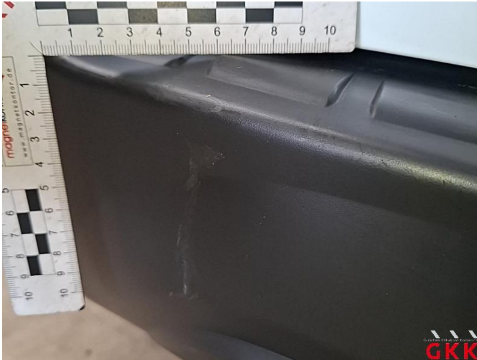
Bild 39. Stoßfänger hinten, Verkleidung -unlackiert-, beschädigt, ersetzen
