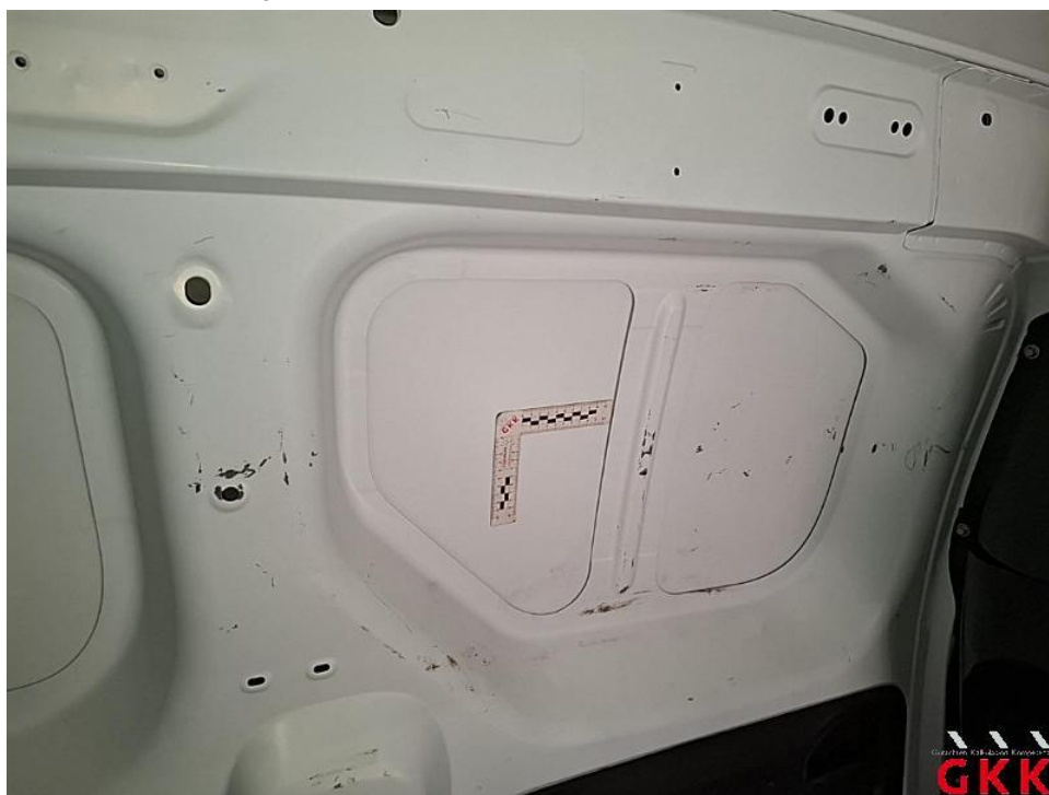
Bild 63. Laderaum, verkratzt, Smartrepair
