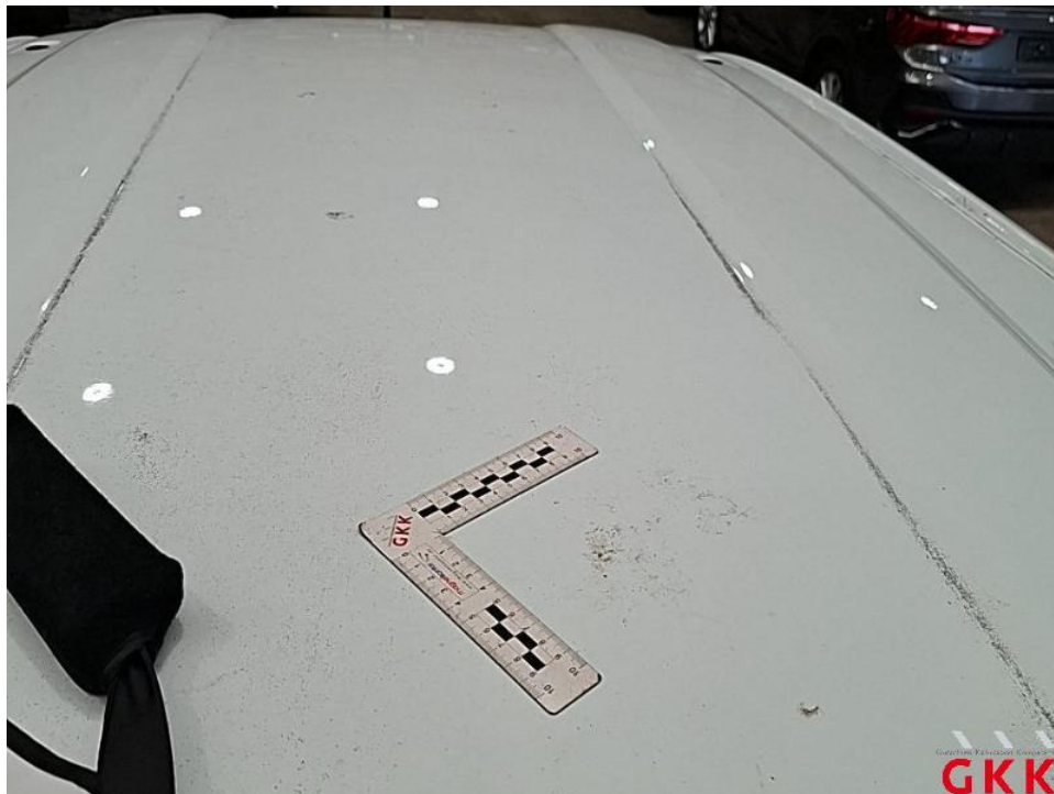
Bild 60. Dach, Lackierung verätzt, lackieren
