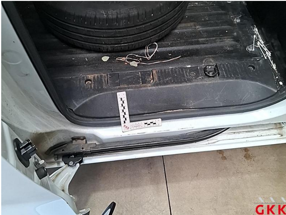
Bild 55. Schiebetür rechts, Einstieg, beschädigt, lackieren
