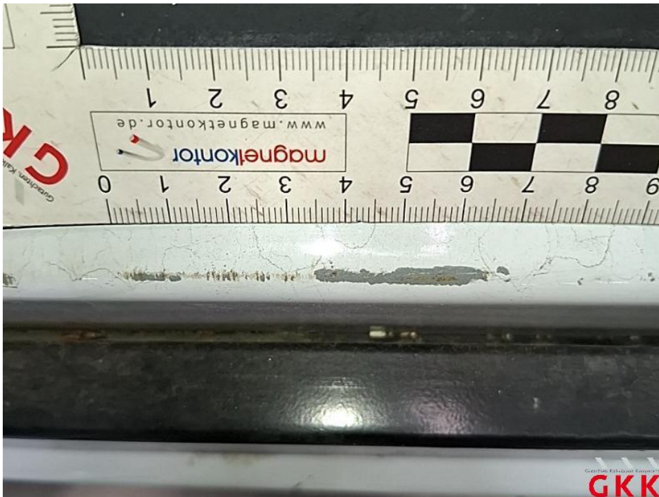
Bild 56. Schiebetür rechts, Einstieg, beschädigt, lackieren
