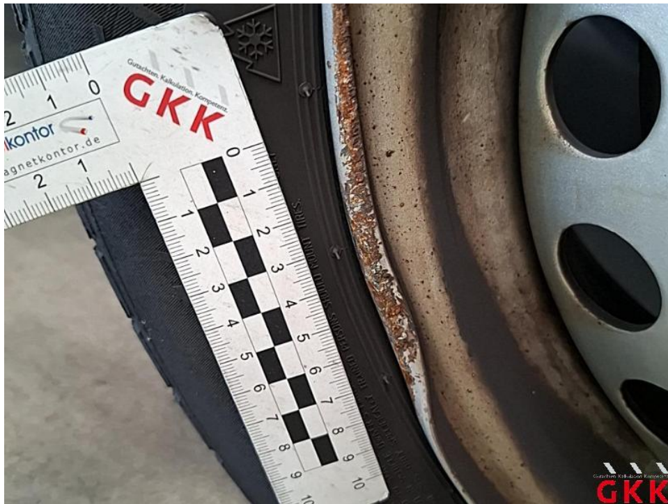
Bild 17. Stahlrad, vorne rechts, beschädigt, ersetzen
