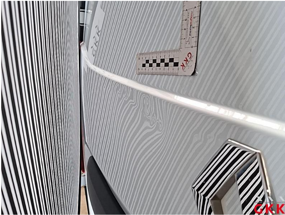
Bild 35. Hecktür links, beschädigt, ersetzen
