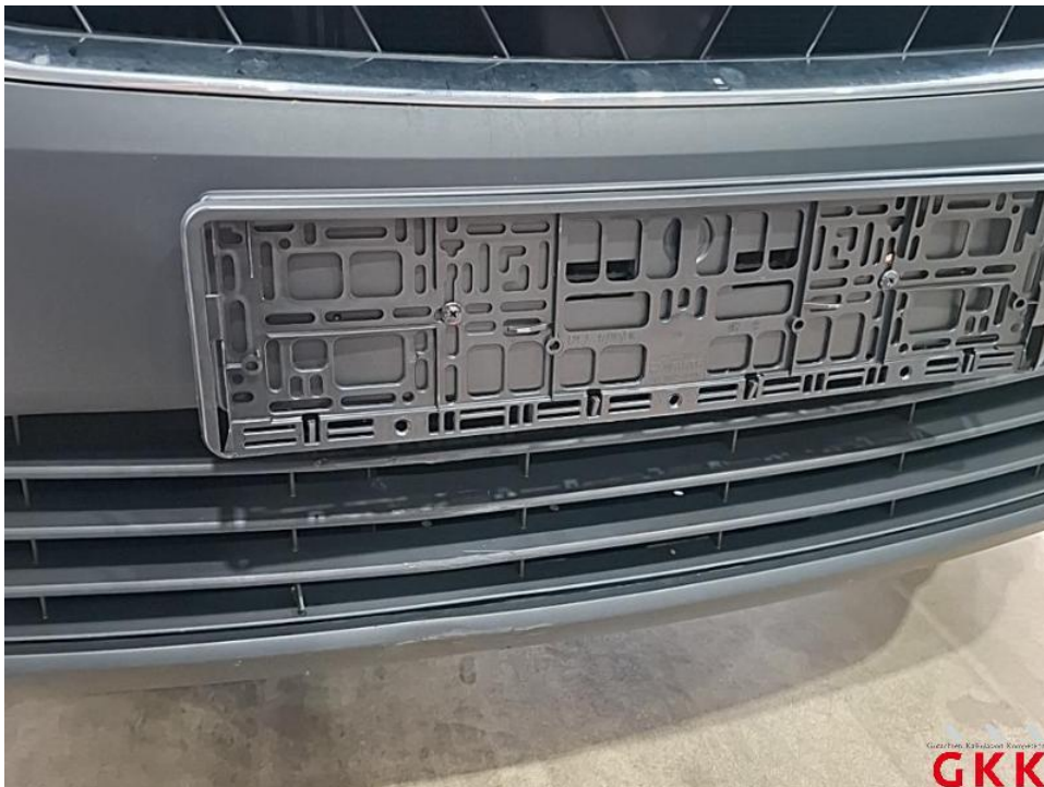
Bild 22. Stoßfänger vorne, Luftgitter, beschädigt, ersetzen
