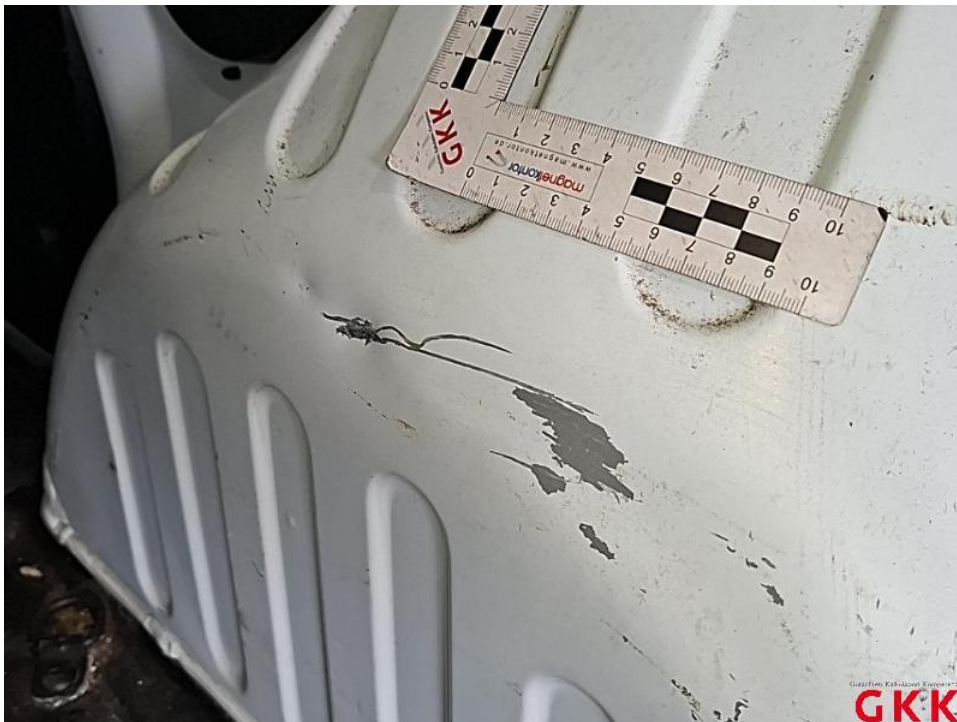
Bild 44. Radhaus hinten rechts, beschädigt, instand setzen - lackieren
