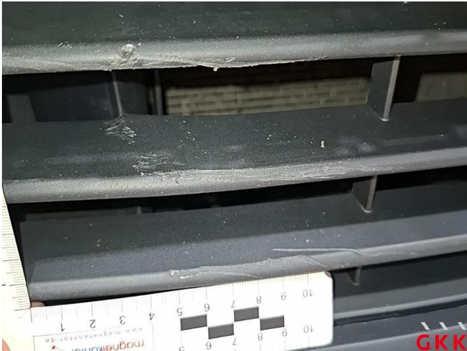
Bild 24. Stoßfänger vorne, Luftgitter, beschädigt, ersetzen
