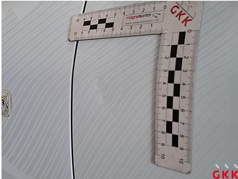
Bild 27. Tür vorne links, bis 3 Dellen / Bauteil, Smartrepair
