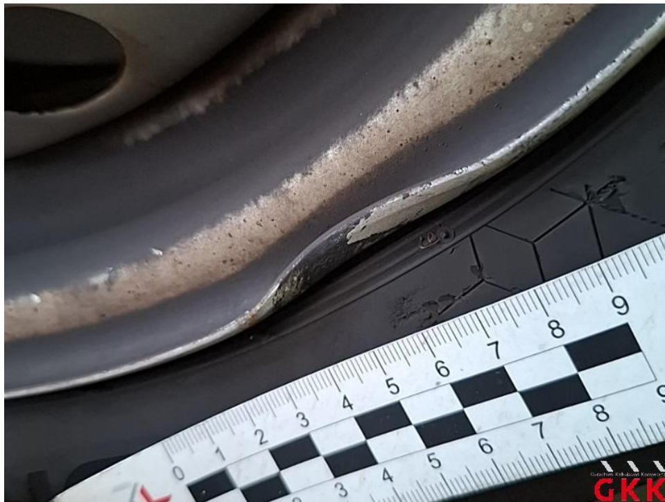
Bild 18. Stahlrad, vorne rechts, beschädigt, ersetzen
