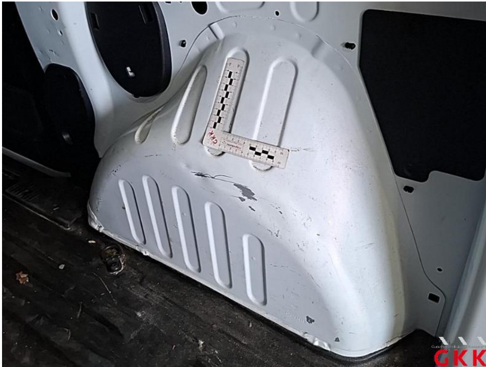
Bild 43. Radhaus hinten rechts, beschädigt, instand setzen - lackieren
