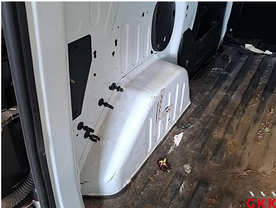
Bild 40. Radhaus hinten links, beschädigt, instand setzen - lackieren
