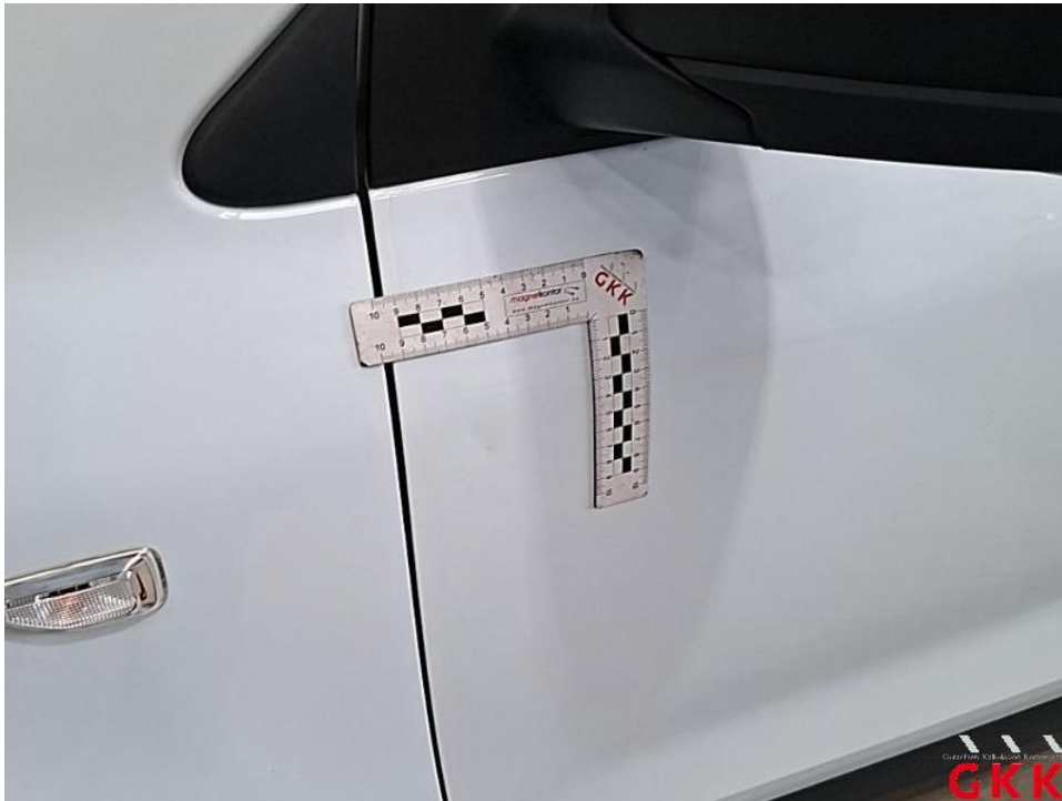
Bild 25. Tür vorne links, bis 3 Dellen / Bauteil, Smartrepair
