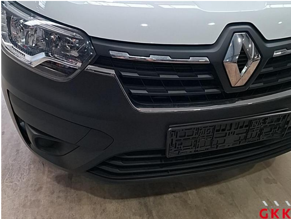
Bild 19. Stoßfänger vorne, Verkleidung -unlackiert-, beschädigt, ersetzen
