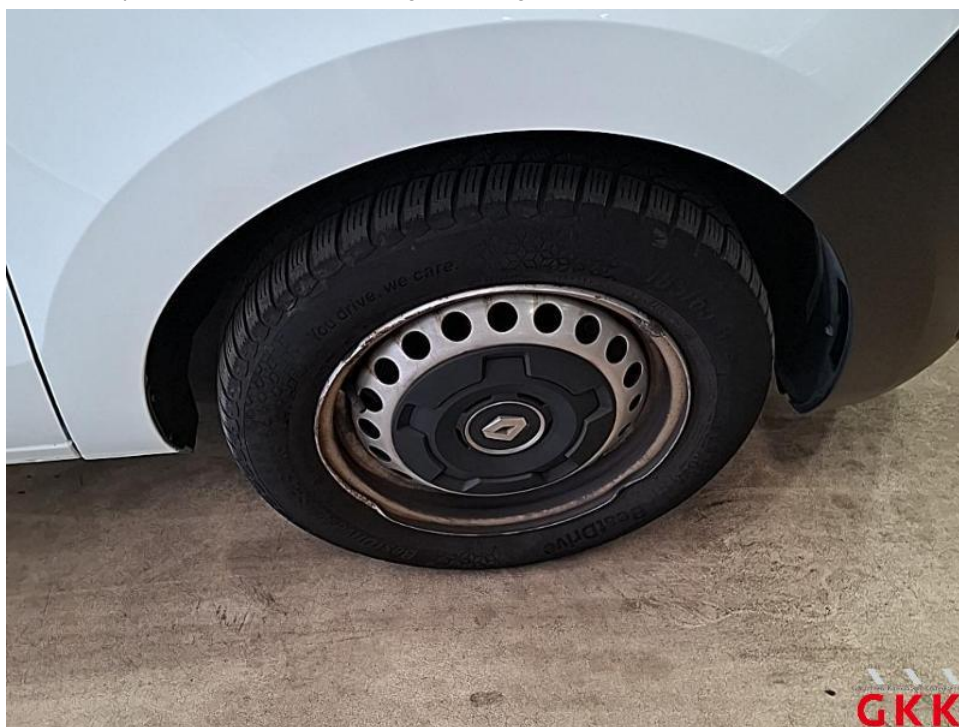
Bild 16. Stahlrad, vorne rechts, beschädigt, ersetzen
