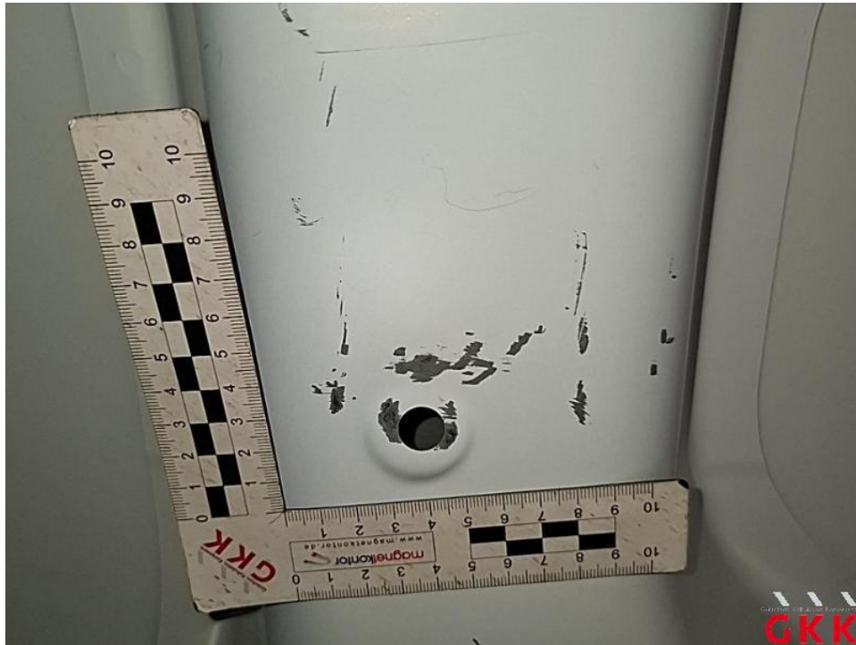
Bild 64. Laderaum, verkratzt, Smartrepair
