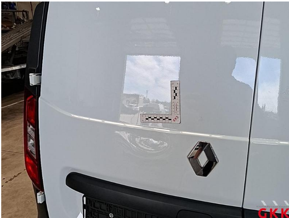
Bild 34. Hecktür links, beschädigt, ersetzen
