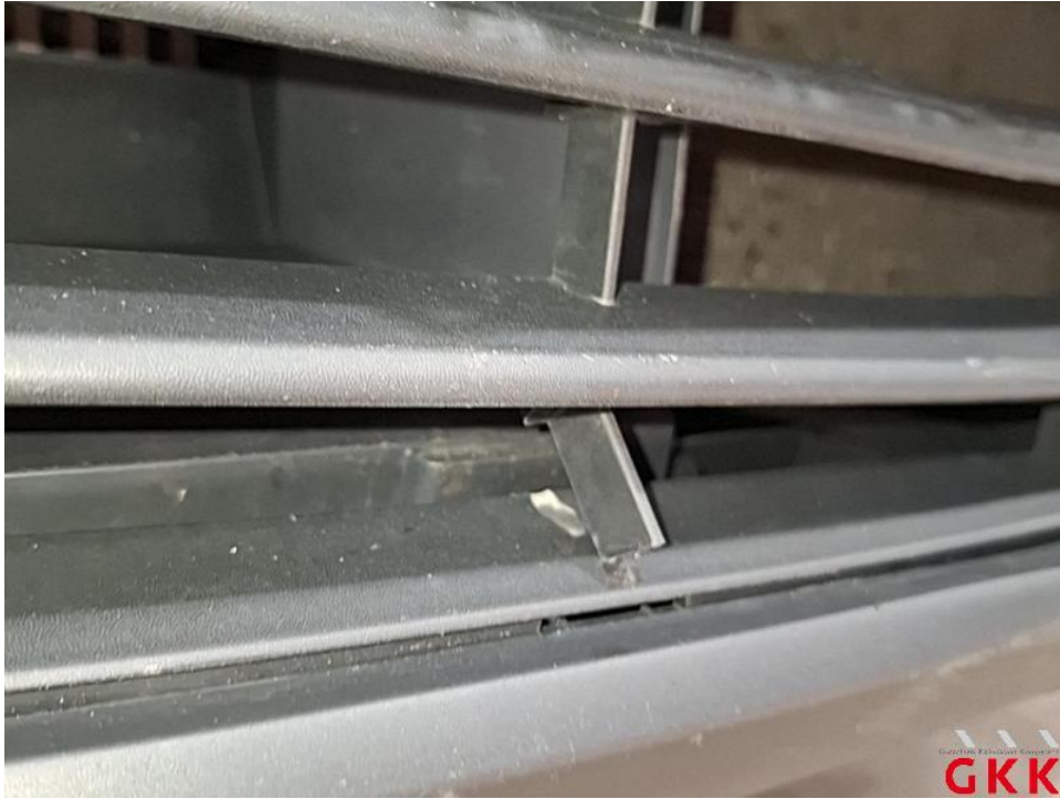
Bild 23. Stoßfänger vorne, Luftgitter, beschädigt, ersetzen
