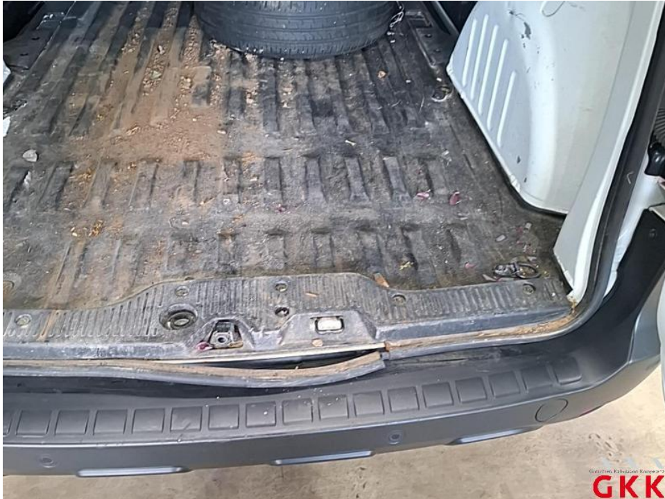
Bild 47. Laderaum, Dichtung, beschädigt, ersetzen
