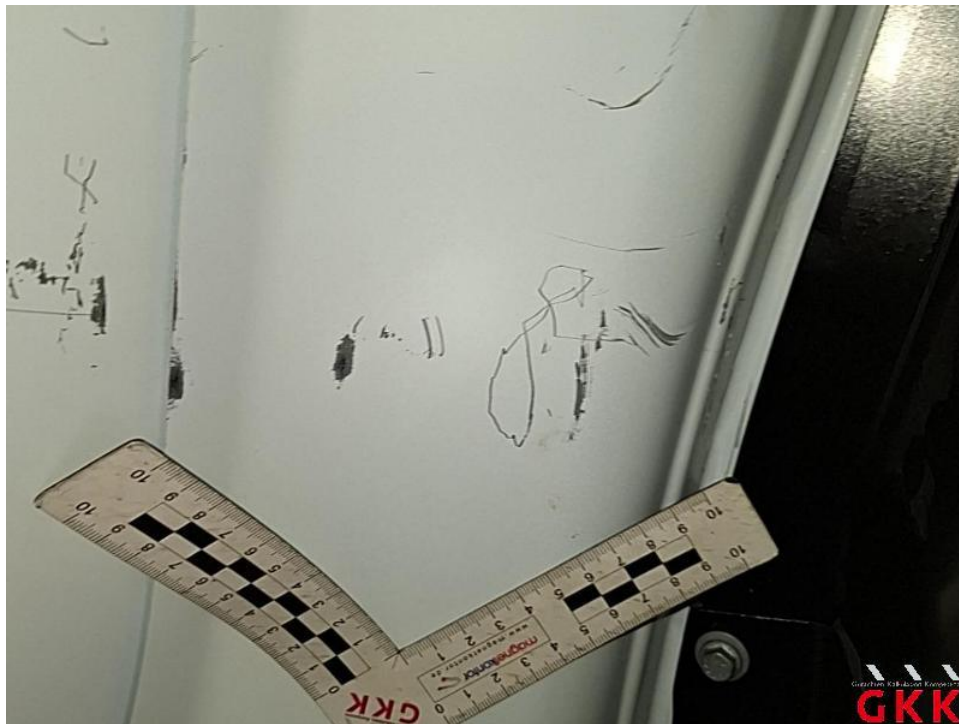
Bild 65. Laderaum, verkratzt, Smartrepair
