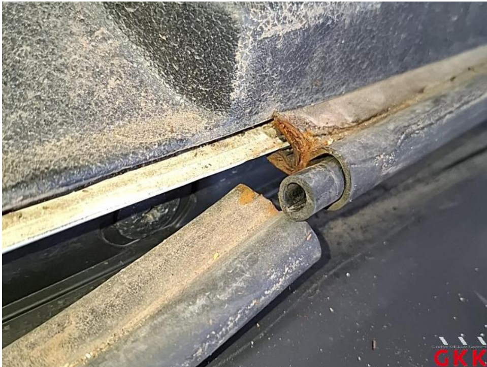
Bild 48. Laderaum, Dichtung, beschädigt, ersetzen
