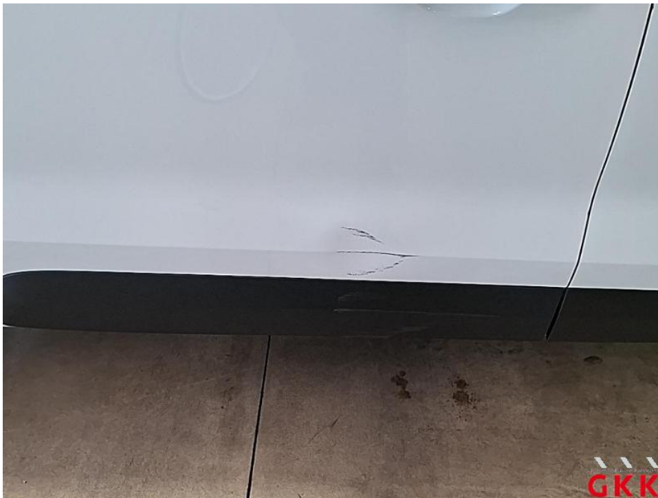
Bild 52. Schiebetür rechts, Leiste -unten-, beschädigt, ersetzen
