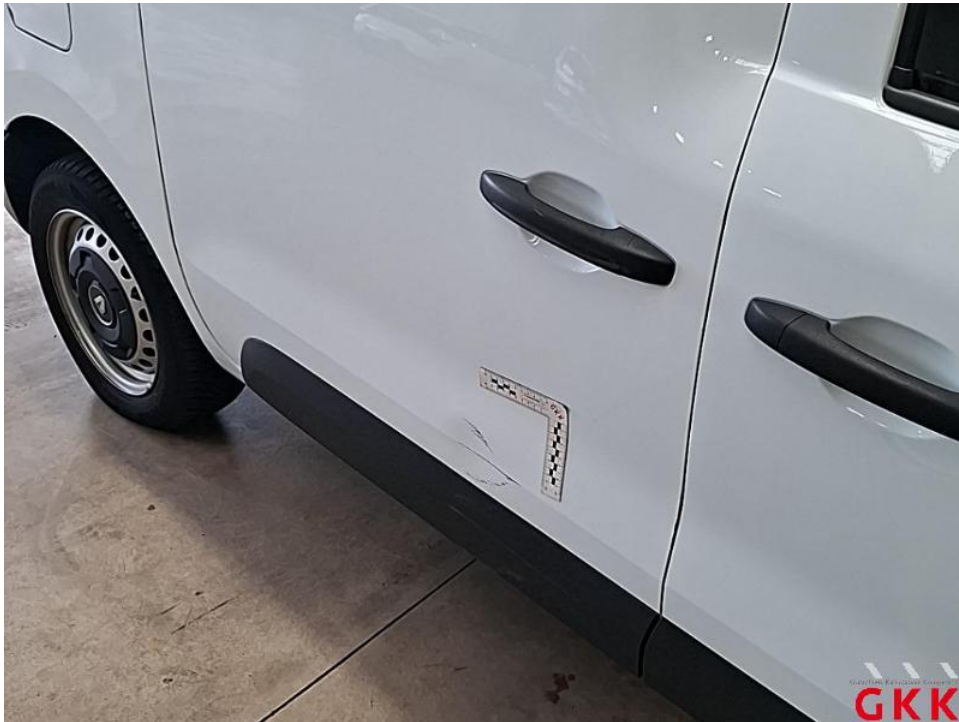
Bild 49. Schiebetür rechts, beschädigt, instand setzen - lackieren
