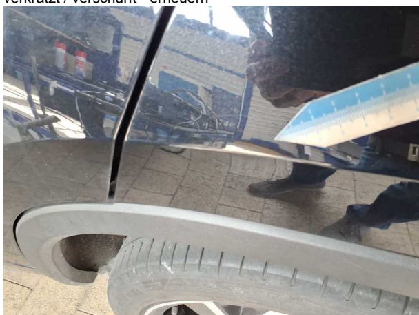
Beschädigung #5: Seitenwand links: Seitenwand - verkratzt / verschürft - lackieren
