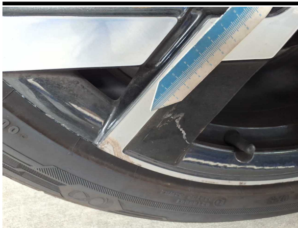
Beschädigung #3: Rad/Reifen: Leichtmetallfelge vorn links - verkratzt / verschürft - erneuern
