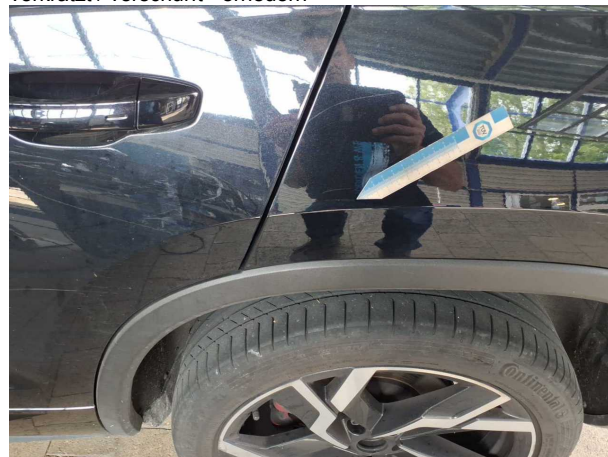
Beschädigung #5: Seitenwand links: Seitenwand - verkratzt / verschürft - lackieren
