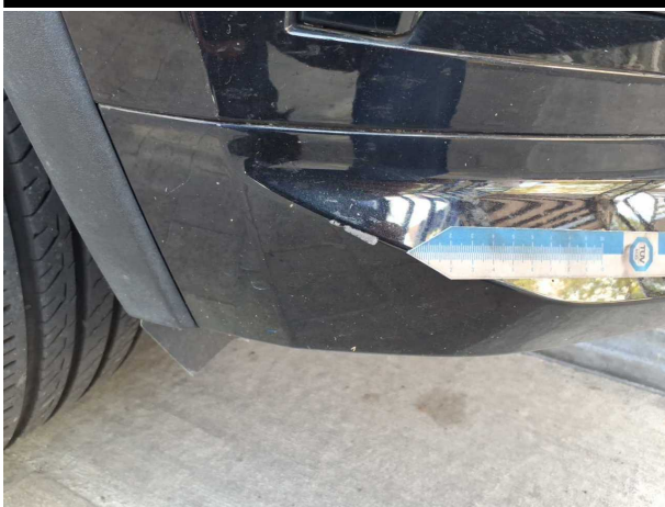
Beschädigung #6: Stossfänger vorn: Stossfänger vorn rechts - verkratzt / verschürft - lackieren
