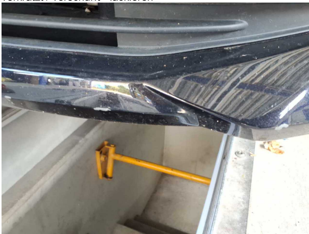
Beschädigung #6: Stossfänger vorn: Stossfänger vorn rechts - verkratzt / verschürft - lackieren
