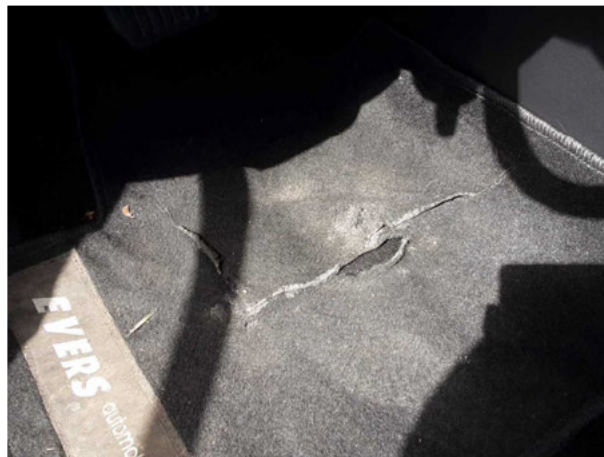
Beschädigung #1: Verkleidungen/Abdeckungen: Fußmatten - gebrochen / gerissen - erneuern
