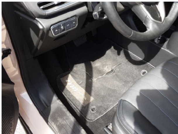
Beschädigung #1: Verkleidungen/Abdeckungen: Fußmatten - gebrochen / gerissen - erneuern
