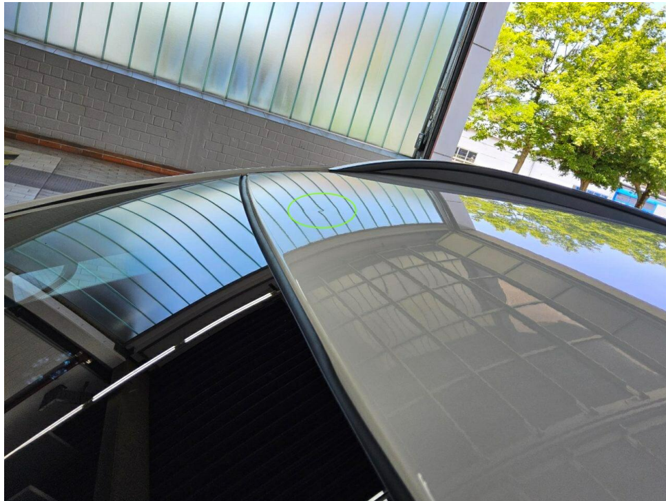
Bild 7 : Dach, mehrfach eingedellt, drücken
