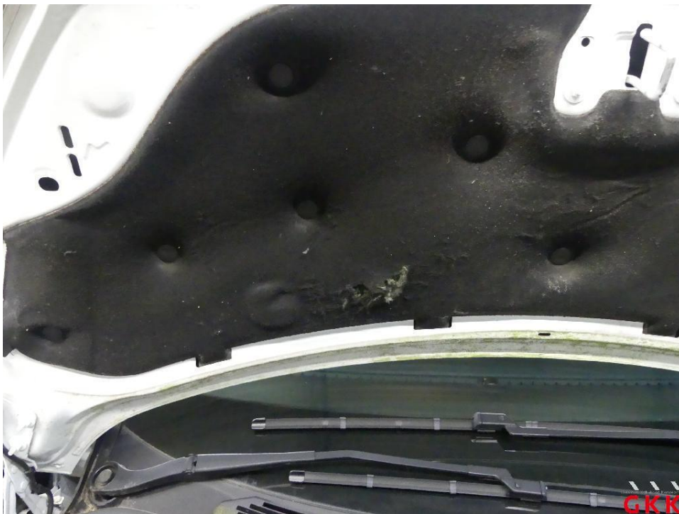
Bild 14 Motorhaube, Dämmmatte, beschädigt, ersetzen
