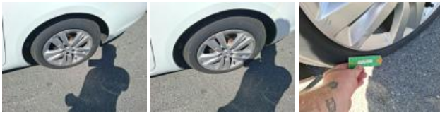
Alloy rim RR, Scratch(es), Repair/replace (lump sum)
