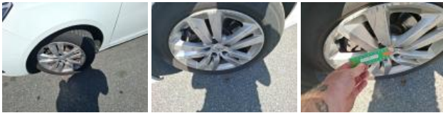
Alloy rim RL, Scratch(es), Repair/replace (lump sum)
