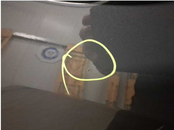
Beschädigung #2: Tür hinten rechts: Tür - Delle / Lackschaden - instandsetzen und lackieren
