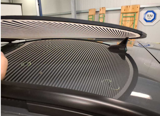
Beschädigung #3: Karosserie: Karosserie (Dach, Dachholm, Heckklappe, Kotflügel, Haube, SW li, Tür HL) - Hagelschaden -
