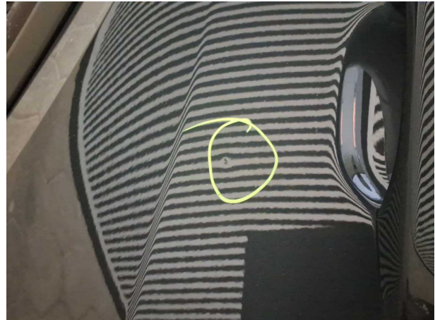
Beschädigung #2: Tür hinten rechts: Tür - Delle / Lackschad... - instandsetzen und lackieren
