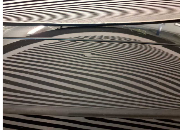
Beschädigung #3: Karosserie: Karosserie (Dach, Dachholm, Heckklappe, Kotflügel, Haube, SW li, Tür HL) - Hagelschaden -
