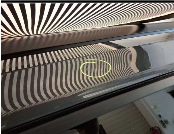
Beschädigung #3: Karosserie: Karosserie (Dach, Dachholm, Heckklappe, Kotflügel, Haube, SW li, Tür HL) - Hagelschaden -
