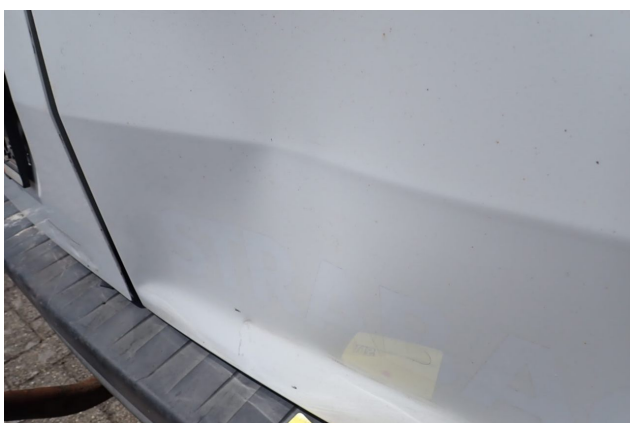
Beschädigung 11: Heckklappe/-tür: Hecktür rechts - Delle / Lackschaden - erneuern
