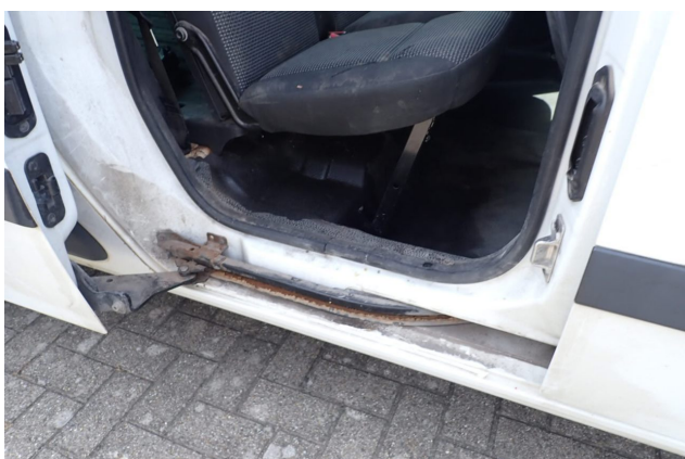
Beschädigung 3: Schiebetür rechts: Führungsschiene - Korrosion - kein Abzug
