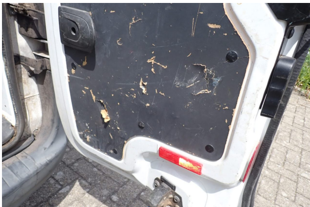
Beschädigung 11: Heckklappe/-tür: Hecktür rechts - Delle / Lackschaden - erneuern
