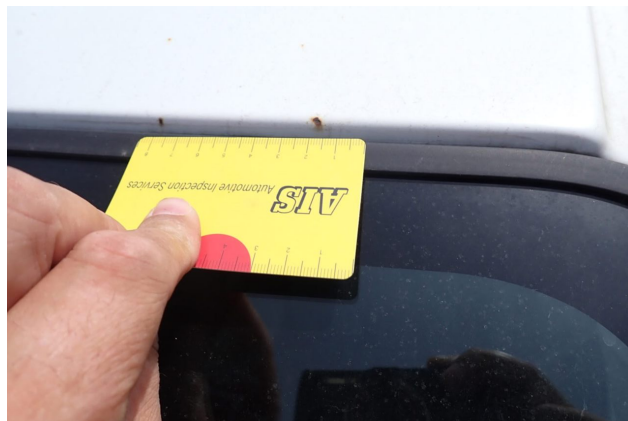
Gebrauchsspur 1: Fahrzeugdach: Dach - Delle / Lackschaden - kein Abzug
