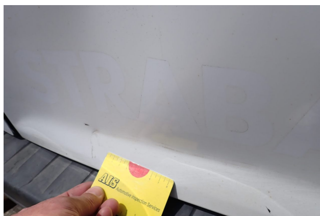
Beschädigung 11: Heckklappe/-tür: Hecktür rechts - Delle / Lackschaden - erneuern
