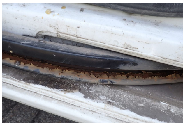
Beschädigung 3: Schiebetür rechts: Führungsschiene - Korrosion - kein Abzug
