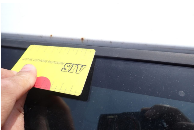
Gebrauchsspur 1: Fahrzeugdach: Dach - Delle / Lackschaden - kein Abzug
