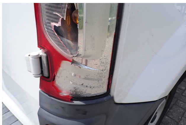
Beschädigung 5: Heckleuchte: Heckleuchte rechts - gebrochen / gerissen - erneuern
