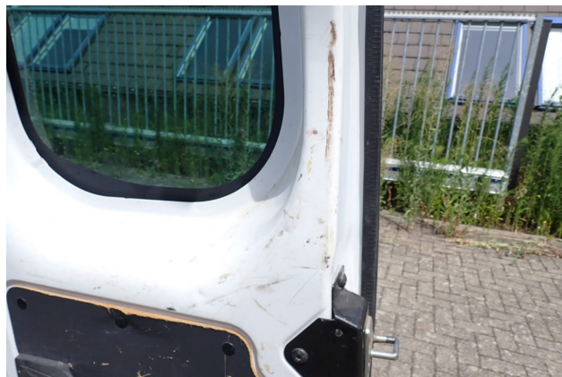
Beschädigung 11: Heckklappe/-tür: Hecktür rechts - Delle / Lackschaden - erneuern
