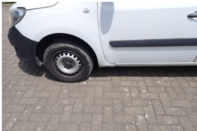
Beschädigung 9: Kotflügel links: Kotflügel links - gebrochen / gerissen - erneuern
