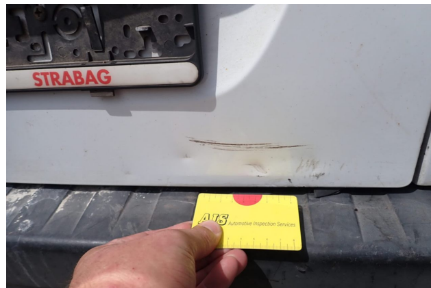
Beschädigung 6: Heckklappe/-tür: Hecktür links - Delle / Lackschaden - instandsetzen und lackieren
