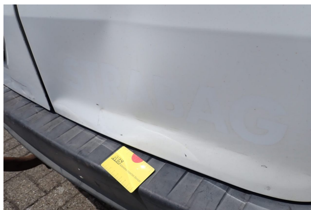
Beschädigung 11: Heckklappe/-tür: Hecktür rechts - Delle / Lackschaden - erneuern
