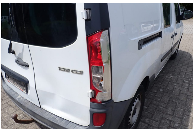
Beschädigung 5: Heckleuchte: Heckleuchte rechts - gebrochen / gerissen - erneuern
