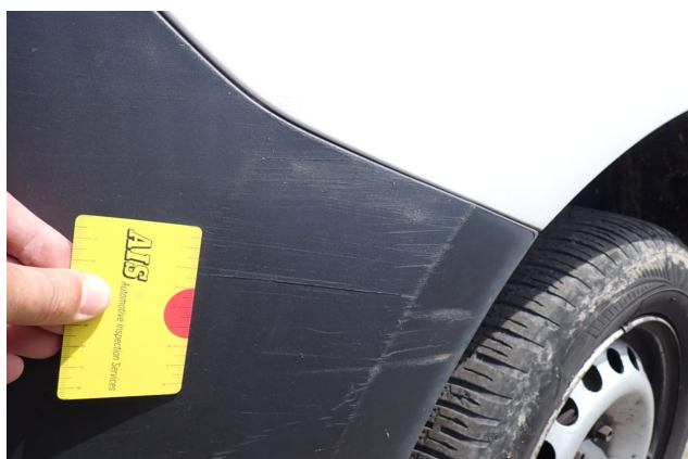
Beschädigung 10: Stossfänger vorn: Stossfänger vorn (unlackiert) - verkratzt / verschürft - erneuern
