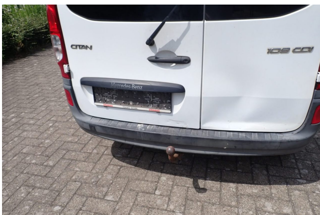
Beschädigung 11: Heckklappe/-tür: Hecktür rechts - Delle / Lackschaden - erneuern
