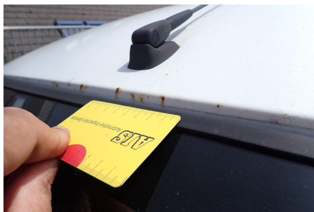
Gebrauchsspur 1: Fahrzeugdach: Dach - Delle / Lackschaden - kein Abzug
