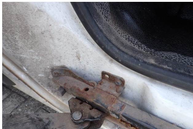
Beschädigung 3: Schiebetür rechts: Führungsschiene - Korrosion - kein Abzug
