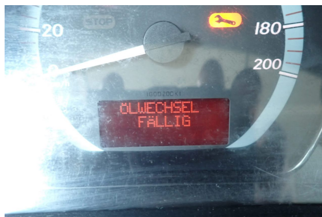
Beschädigung 8: Sonstiges: Inspektion/Wartung - fällig - durchführen
