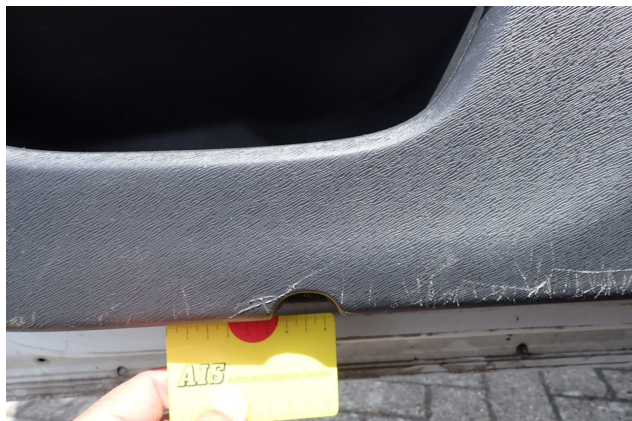
Gebrauchsspur 2: Verkleidungen/Abdeckungen: Türverkleidung vorn links - beschädigt - kein Abzug
