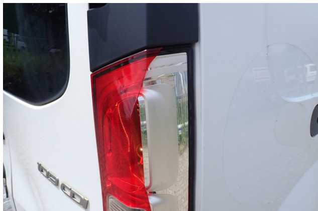
Beschädigung 5: Heckleuchte: Heckleuchte rechts - gebrochen / gerissen - erneuern
