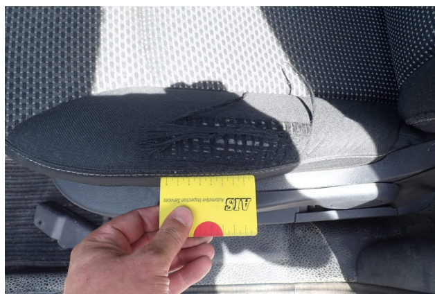
Beschädigung 4: Sitz vorn: Sitzbezug links - gebrochen / gerissen - erneuern
