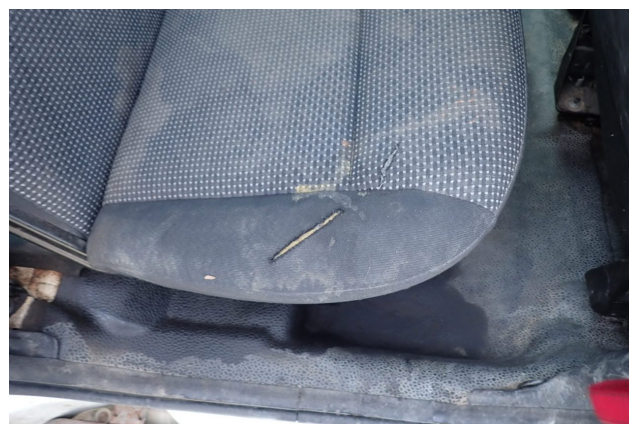
Beschädigung 7: Sitz hinten: Rücksitz - beschädigt - erneuern
