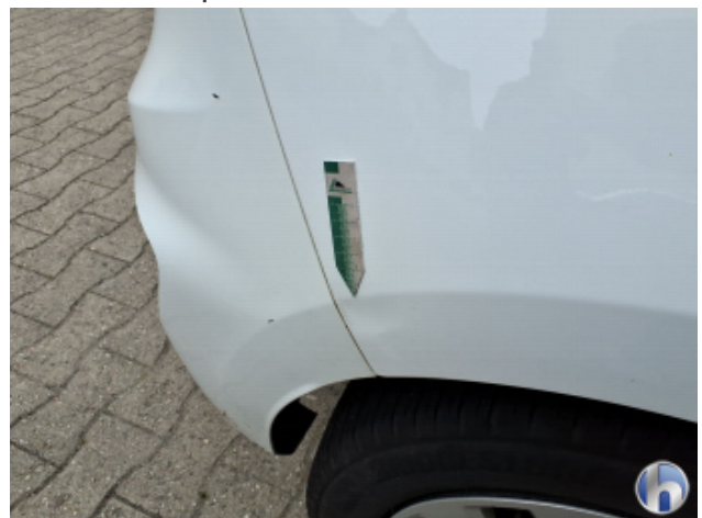
3. Seitenwand - Hinten - Rechts Beschädigt - Instandsetzen und Lackieren
