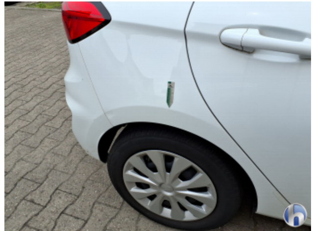
3. Seitenwand - Hinten - Rechts Beschädigt - Instandsetzen und Lackieren
