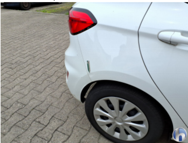
3. Seitenwand - Hinten - Rechts Beschädigt - Instandsetzen und Lackieren
