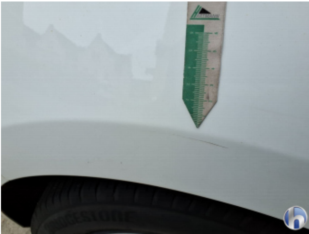
3. Seitenwand - Hinten - Rechts Beschädigt - Instandsetzen und Lackieren
