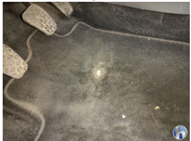
9. Fußraum Innenraum links vorne Loch - Erneuern
