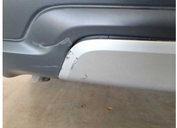
Beschädigung #5: Stossfänger hinten: Spoiler - verformt - erneuern
