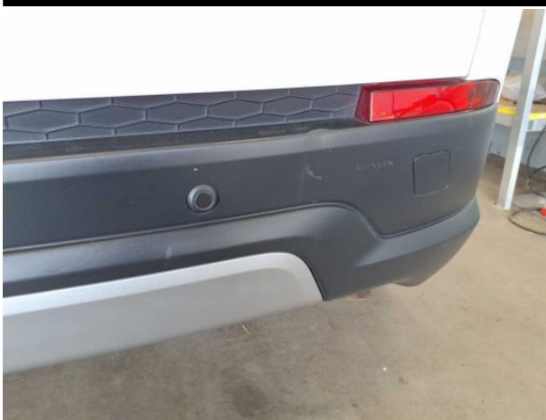
Beschädigung #7: Stossfänger hinten: Stossfänger hinten (unlackiert) - verformt - erneuern
