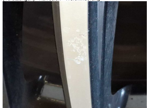
Beschädigung #2: Rad/Reifen: Leichtmetallfelge hinten links (Verätzungen) - Korrosion - Wertminderung
