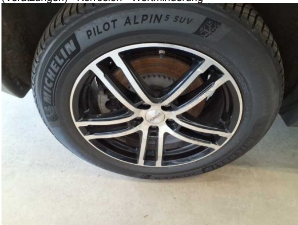
Beschädigung #3: Rad/Reifen: Leichtmetallfelge hinten rechts (Verätzungen) - Korrosion - Wertminderung
