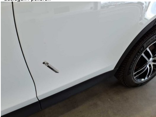
Beschädigung #6: Karosserie: Karosserie (Flugrost) - Lackmangel - auslegen / polieren
