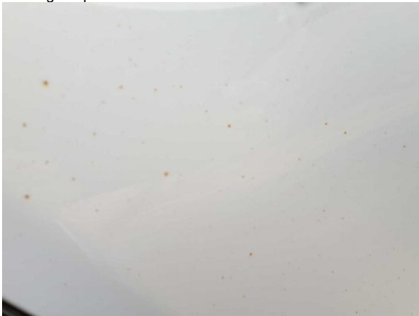
Beschädigung #6: Karosserie: Karosserie (Flugrost) - Lackmangel - auslegen / polieren
