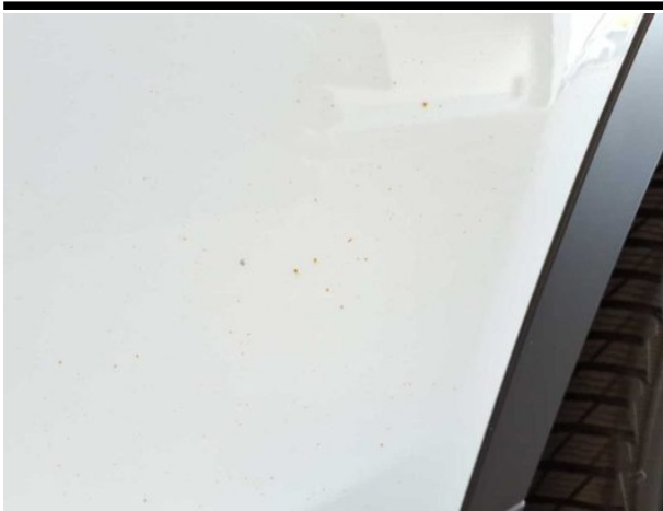
Beschädigung #6: Karosserie: Karosserie (Flugrost) - Lackmangel - auslegen / polieren
