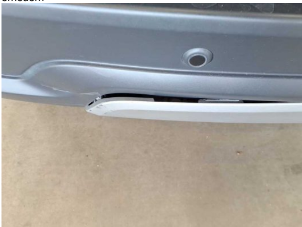
Beschädigung #5: Stossfänger hinten: Spoiler - verformt - erneuern
