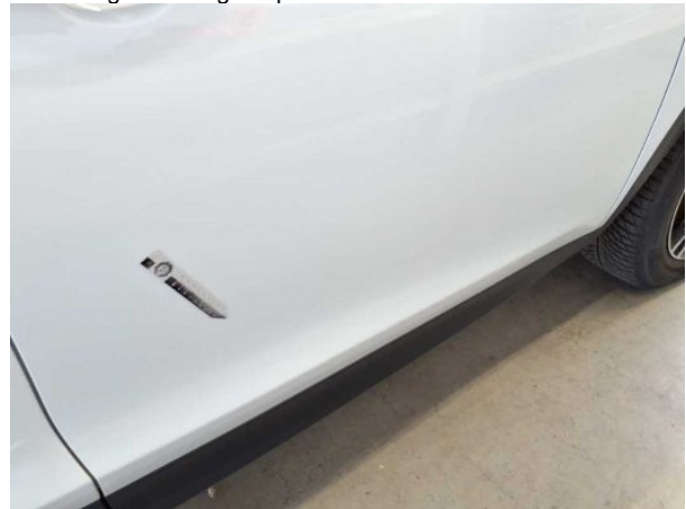
Beschädigung #6: Karosserie: Karosserie (Flugrost) - Lackmangel - auslegen / polieren
