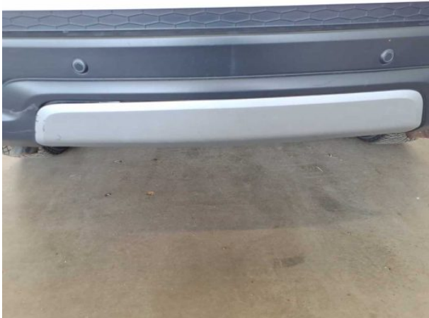
Beschädigung #5: Stossfänger hinten: Spoiler - verformt - erneuern
