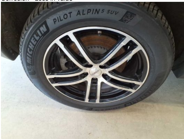
Damage #3: Wheel / tyres: Alloy rim - rear right side (Verätzungen) - Corrosion - Loss in value
