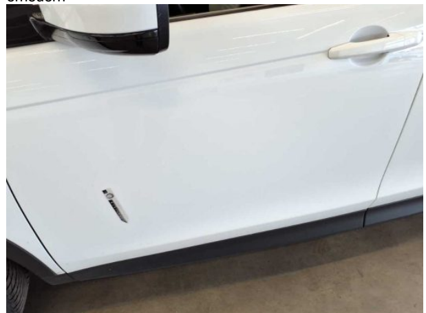
Beschädigung #6: Karosserie: Karosserie (Flugrost) - Lackmangel - auslegen / polieren
