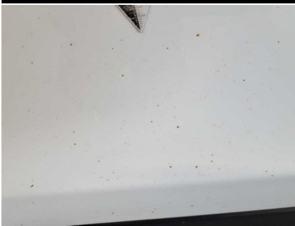
Beschädigung #6: Karosserie: Karosserie (Flugrost) - Lackmangel - auslegen / polieren
