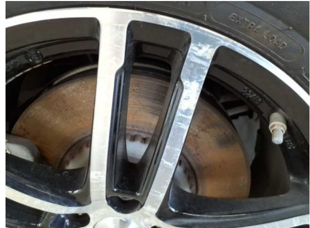
Beschädigung #1: Rad/Reifen: Leichtmetallfelge vorn links (Verätzungen) - Korrosion - Wertminderung
