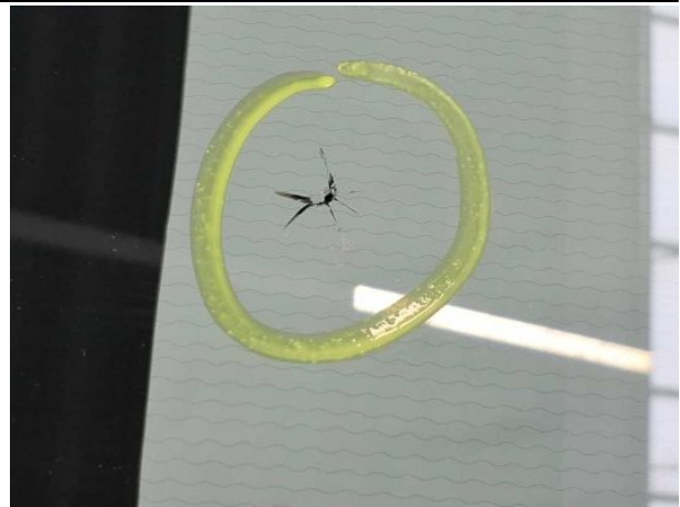
Beschädigung #8: Verglasung: Frontscheibe mit Spurhalteassistent - Steinschlag - erneuern
