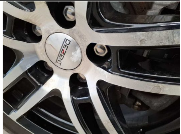
Beschädigung #4: Rad/Reifen: Leichtmetallfelge vorn rechts - Korrosion - Wertminderung
