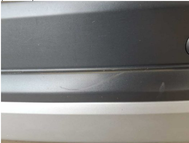
Beschädigung #7: Stossfänger hinten: Stossfänger hinten (unlackiert) - verformt - erneuern
