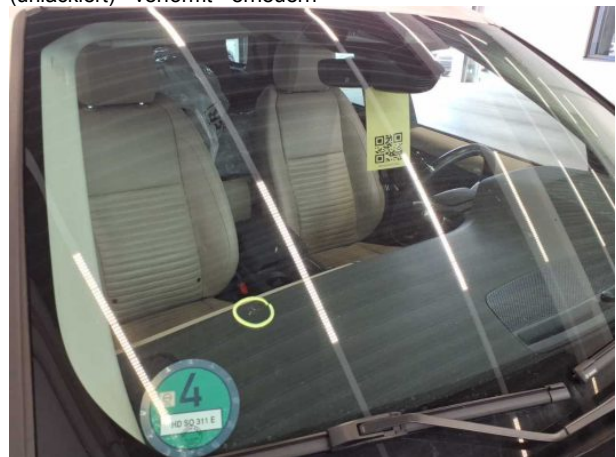
Beschädigung #8: Verglasung: Frontscheibe mit Spurhalteassistent - Steinschlag - erneuern
