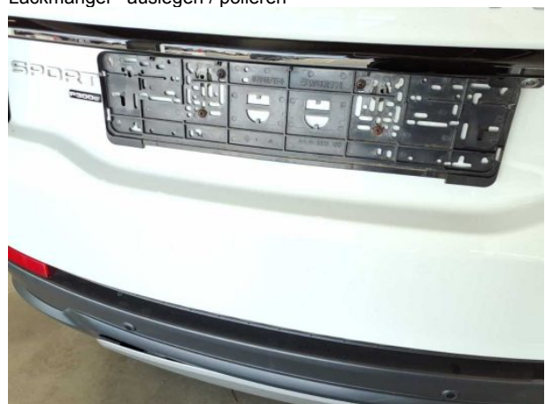
Beschädigung #6: Karosserie: Karosserie (Flugrost) - Lackmangel - auslegen / polieren
