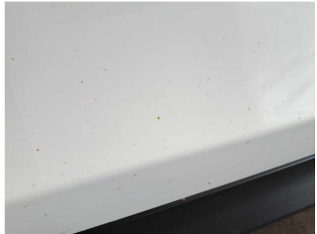
Beschädigung #6: Karosserie: Karosserie (Flugrost) - Lackmangel - auslegen / polieren
