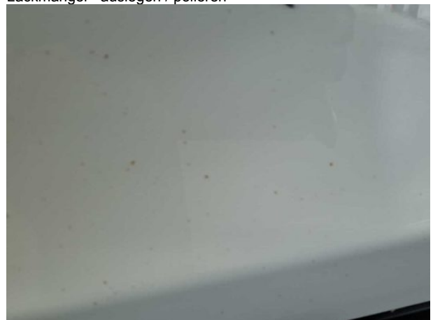
Beschädigung #6: Karosserie: Karosserie (Flugrost) - Lackmangel - auslegen / polieren
