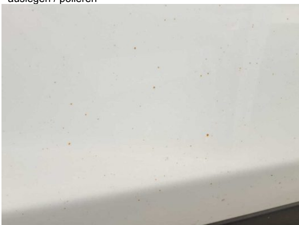
Beschädigung #6: Karosserie: Karosserie (Flugrost) - Lackmangel - auslegen / polieren
