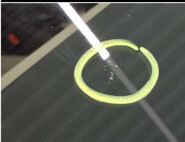
Beschädigung #8: Verglasung: Frontscheibe mit Spurhalteassistent - Steinschlag - erneuern
