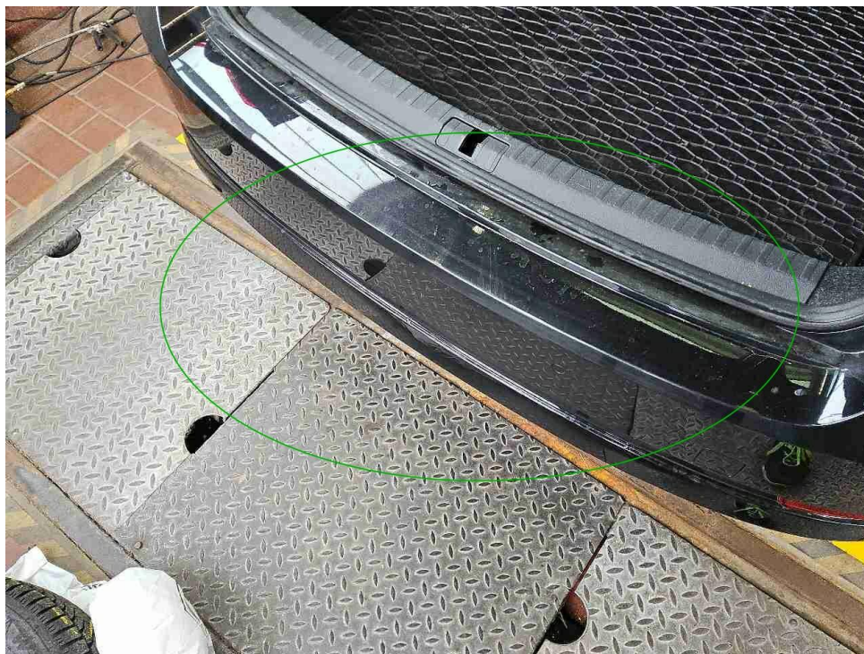
Bild 14 : Stoßfänger hinten zerkratzt
