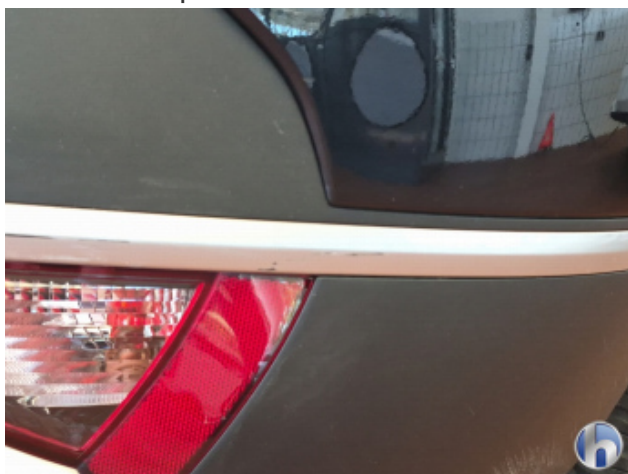
3. Stoßfänger Hinten Kratzer - Smart Repair
