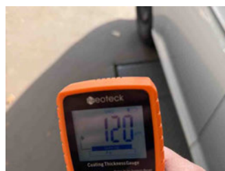
Lackstärke Kotflügel vorne rechts
