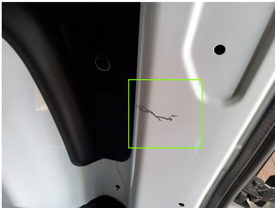
Bild 13 : Gebrauchsspur D-Säule rechts verschrammt
