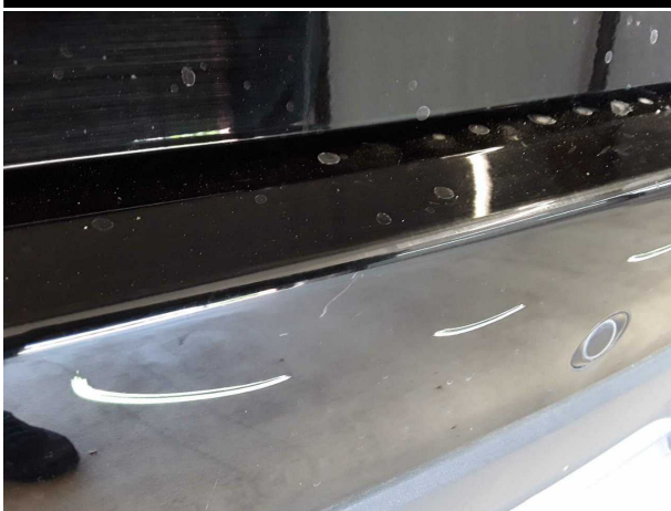
Beschädigung #4: Stossfänger hinten: Stossfänger hinten - verkratzt / verschürft - Wertminderung
