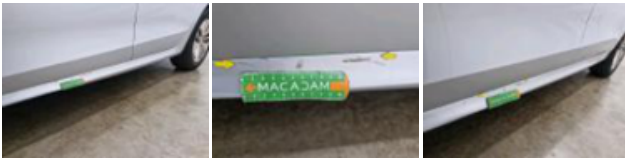
Aile ARG, Bosse(s) et griffe(s), LI - Réparer et peindre (complet)
