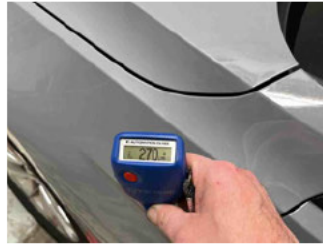
Lackstärke Kotflügel vorne links
