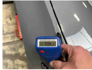
Lackstärke Kotflügel vorne rechts
