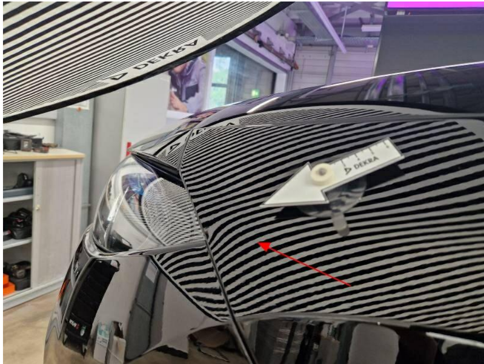
Bild 25 : Kotflügel vorne links eingezogen
