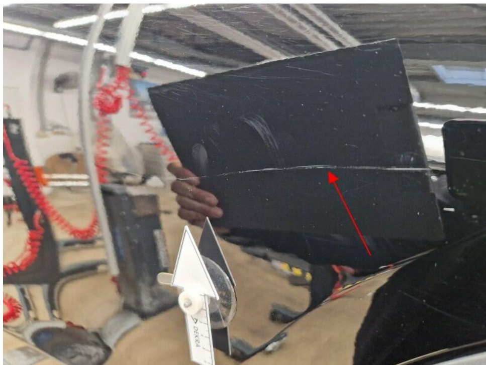
Bild 16 : Tür hinten links Lackierung, zerkratzt, lackieren mit Lackaufbau
