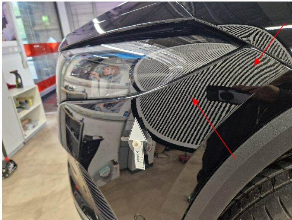
Bild 21 : Stoßfänger vorne linksseitig eingezogen
