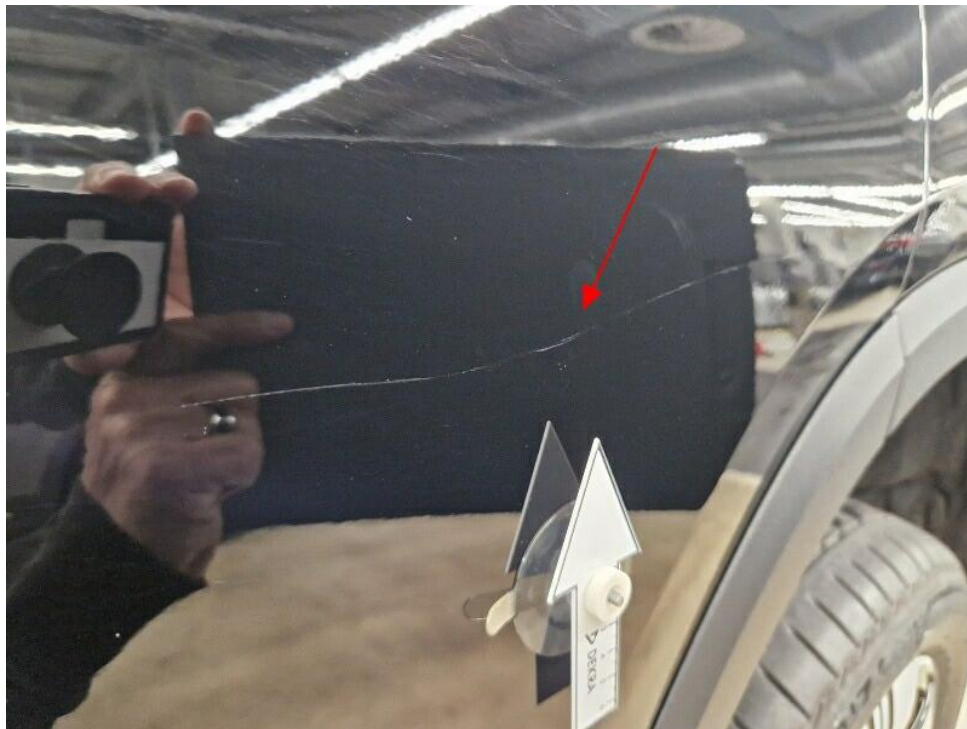
Bild 15 : Tür hinten links Lackierung, zerkratzt, lackieren mit Lackaufbau
