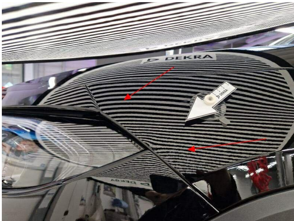
Bild 24 : Kotflügel vorne links eingezogen
