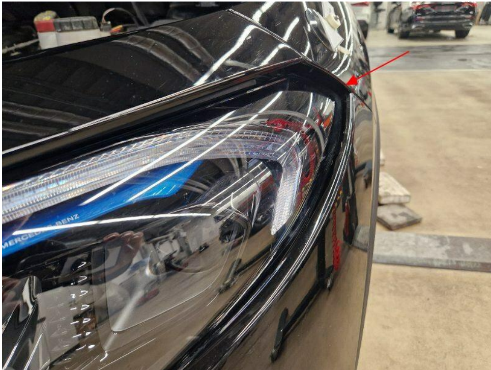
Bild 19 : Scheinwerfer links ausgebrochen
