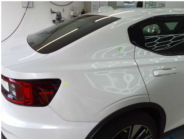
Beschädigung #6: Seitenwand rechts: Seitenwand - nicht fachgerecht instandgesetzt - instandsetzen und lackieren
