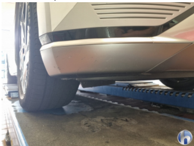
4. Frontspoiler Kratzer - Smart Repair
