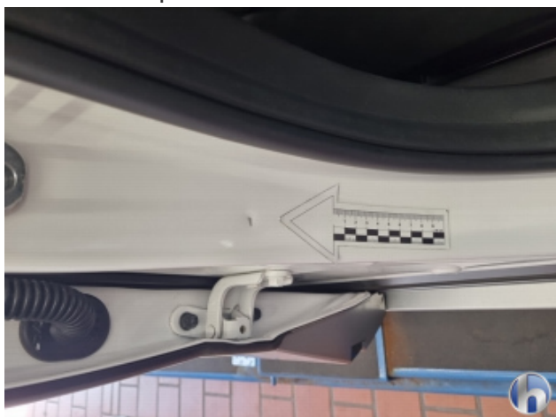
3. B-Säule Mitte - Rechts 1 Delle - Smart Repair
