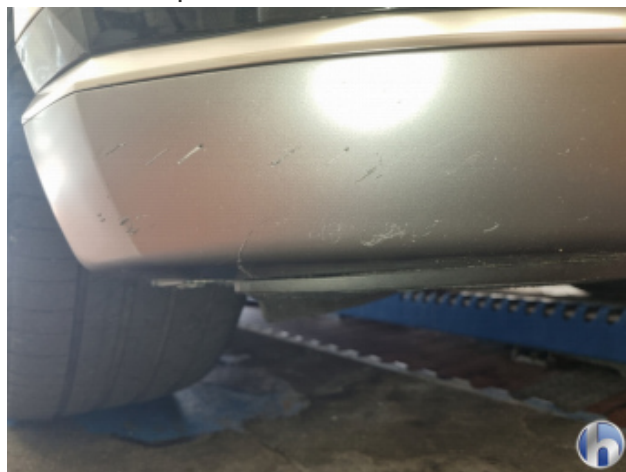
4. Frontspoiler Kratzer - Smart Repair
