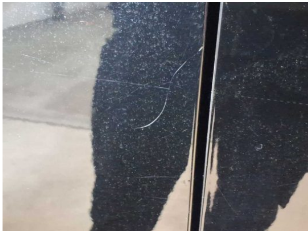
Beschädigung 10: Schiebetür links: Schiebetür mit Glasscheibe - Delle / Lackschaden - Smart Repair
