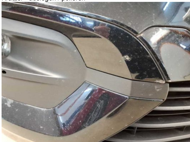
Beschädigung 3: Stossfänger vorn: Lufteinlassgitter - verkratzt / verschürft - erneuern
