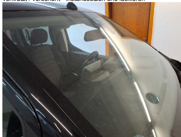
Beschädigung 13: Verglasung: Frontscheibe - Steinschlag - erneuern
