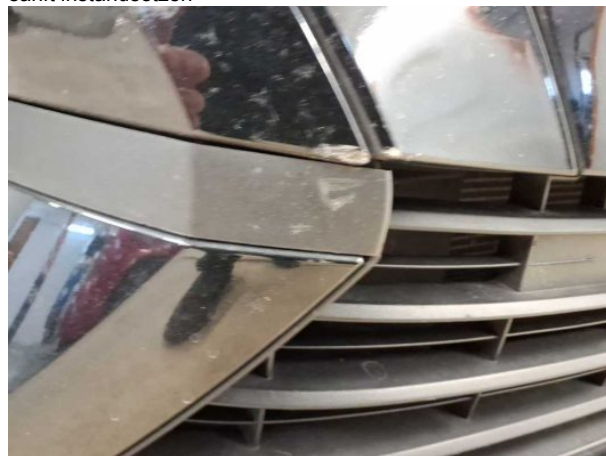
Beschädigung 3: Stossfänger vorn: Lufteinlassgitter - verkratzt / verschürft - erneuern
