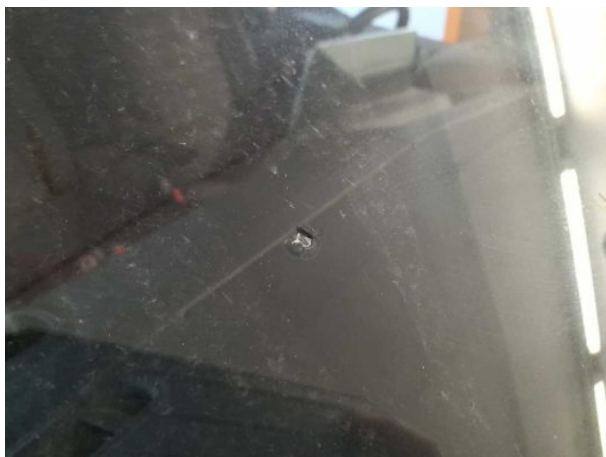
Beschädigung 13: Verglasung: Frontscheibe - Steinschlag - erneuern
