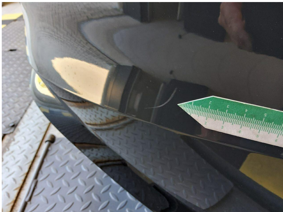
Bild 22 : Stoßfänger hinten zerkratzt
