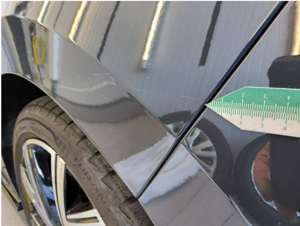
Bild 17 : Seitenwand hinten links zerkratzt
