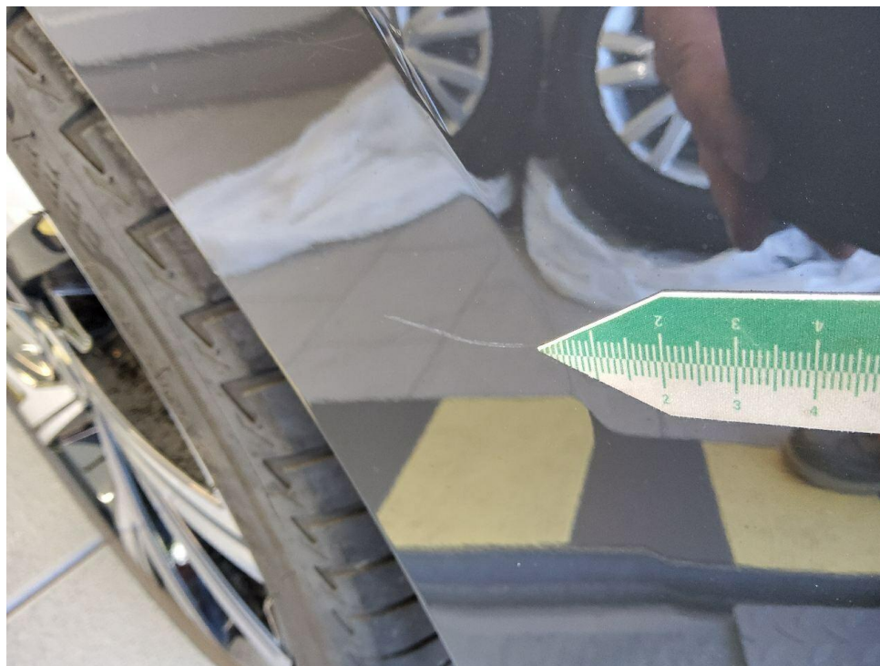
Bild 24 : Stoßfänger hinten zerkratzt
