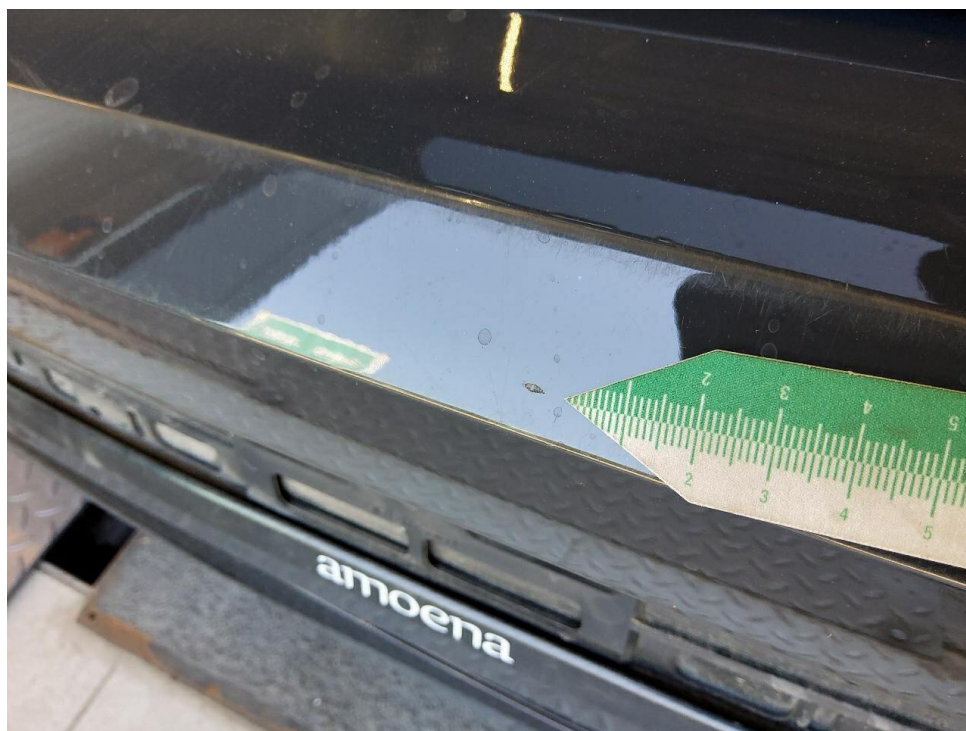
Bild 23 : Stoßfänger hinten zerkratzt
