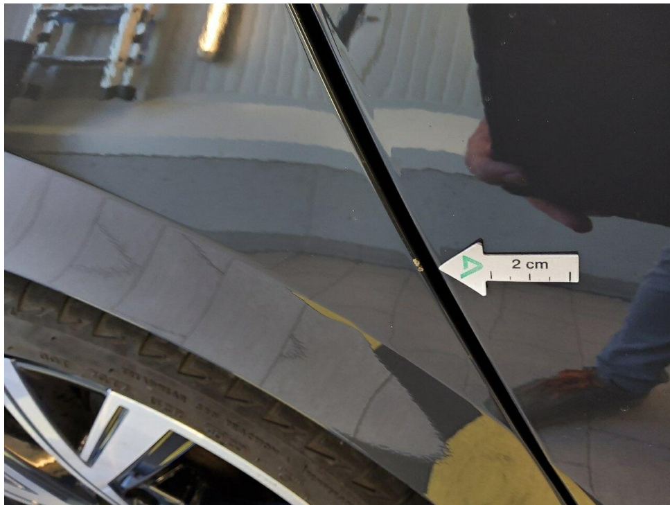
Bild 19 : Seitenwand hinten rechts zerkratzt
