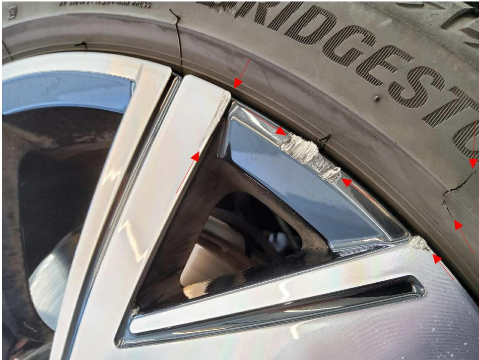
Bild 25 : Sommer LM-Felge vorne rechts verschrammt (glanzgedreht) Reifen vorne rechts schadhaf
