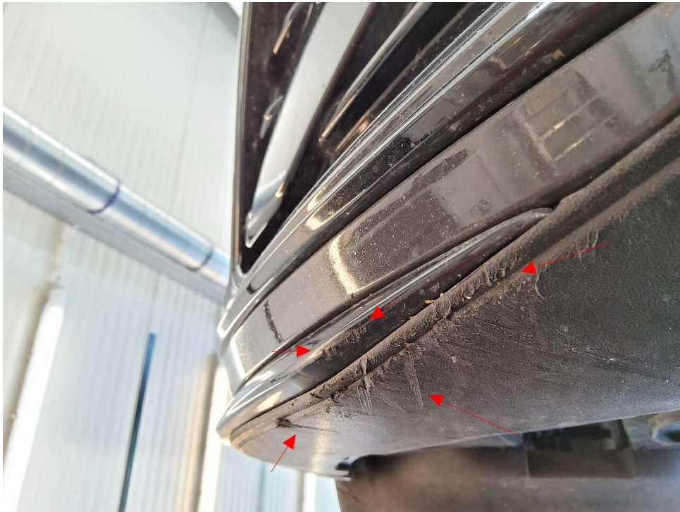
Bild 27 : Zierleisten Stoßfänger vorn und Spoiler verschrammt
