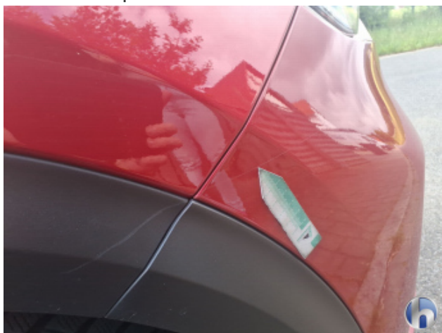
5. Kotflügel Vorne - Rechts Oberflächenkratzer - Auslegen / Polieren
