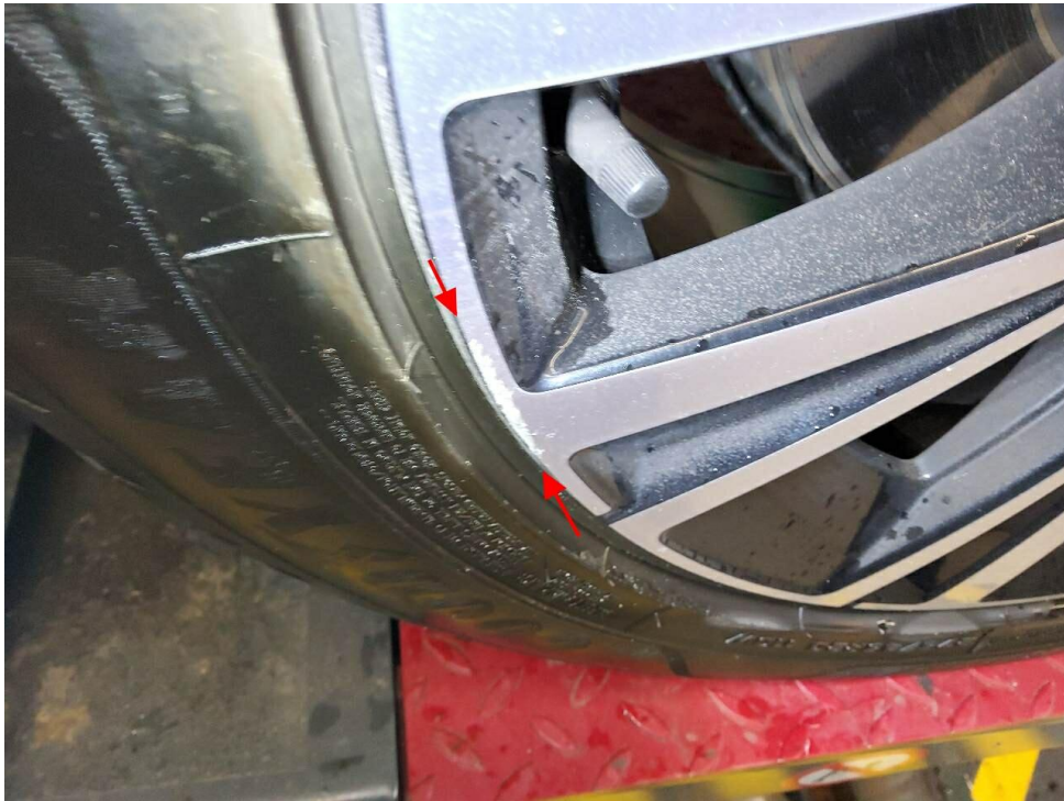
Bild 23 : Felge vorne rechts (glanzgedreht), verschrammt mit Materialabtrag
