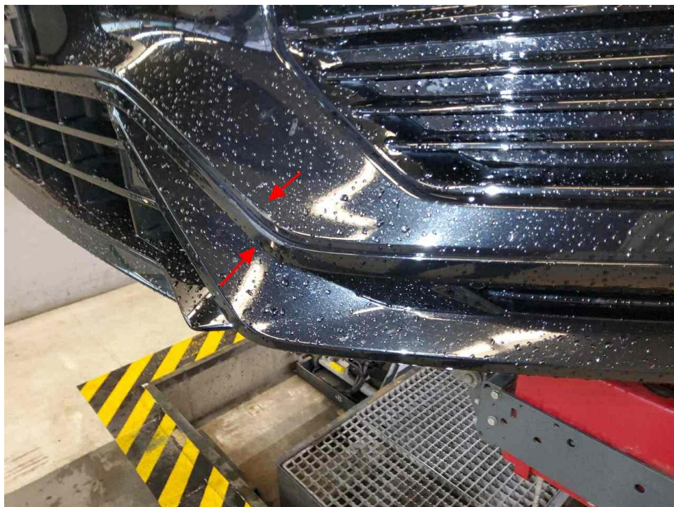
Bild 28 : Stoßfänger vorne Lackierung, verschrammt, lackieren mit Lackaufbau Frontspoiler Lackierung, verschrammt, lackieren mit Lackaufbau
