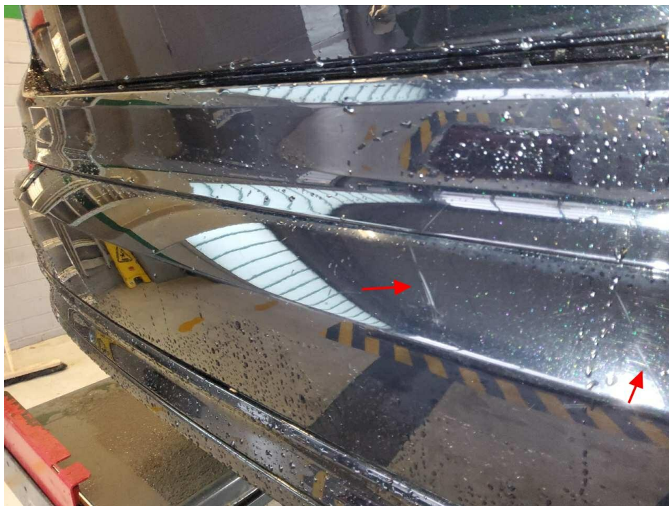
Bild 18 : Stoßfänger hinten Lackierung, zerkratzt, Gebrauchsspur
