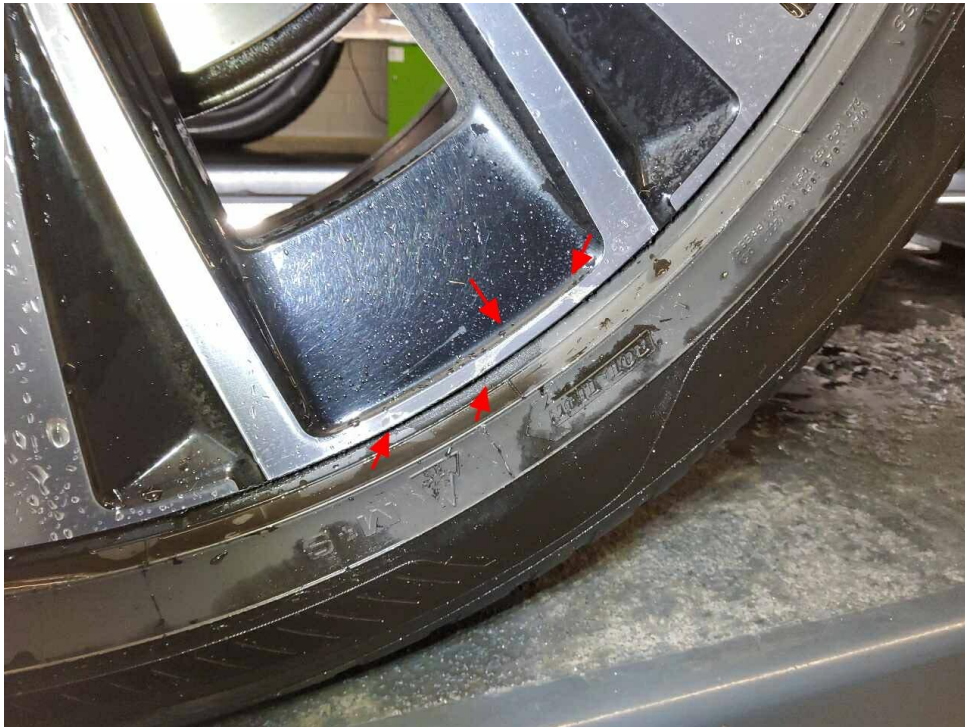
Bild 21 : Felge hinten rechts (glanzgedreht), verschrammt mit Materialabtrag
