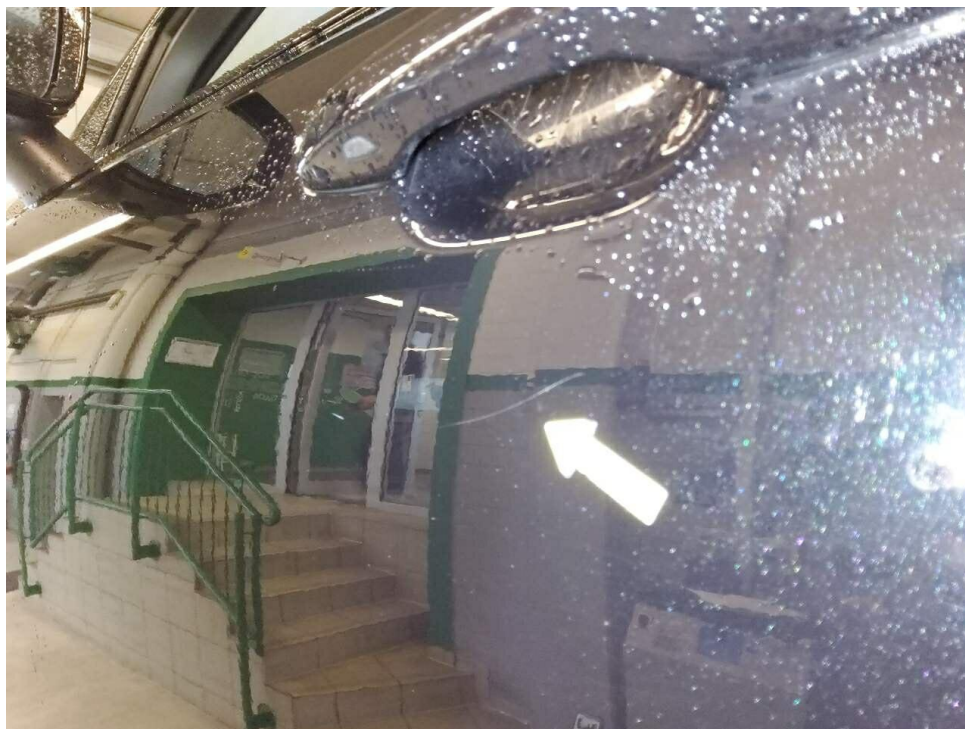
Bild 15 : Tür vorne links Lackierung, zerkratzt, Gebrauchsspur
