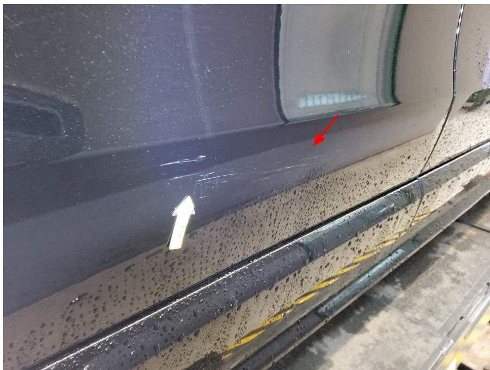
Bild 26 : Tür hinten rechts, eingedellt, Lackierung zerkratzt, instandsetzen und lackieren mit Lackaufbau
