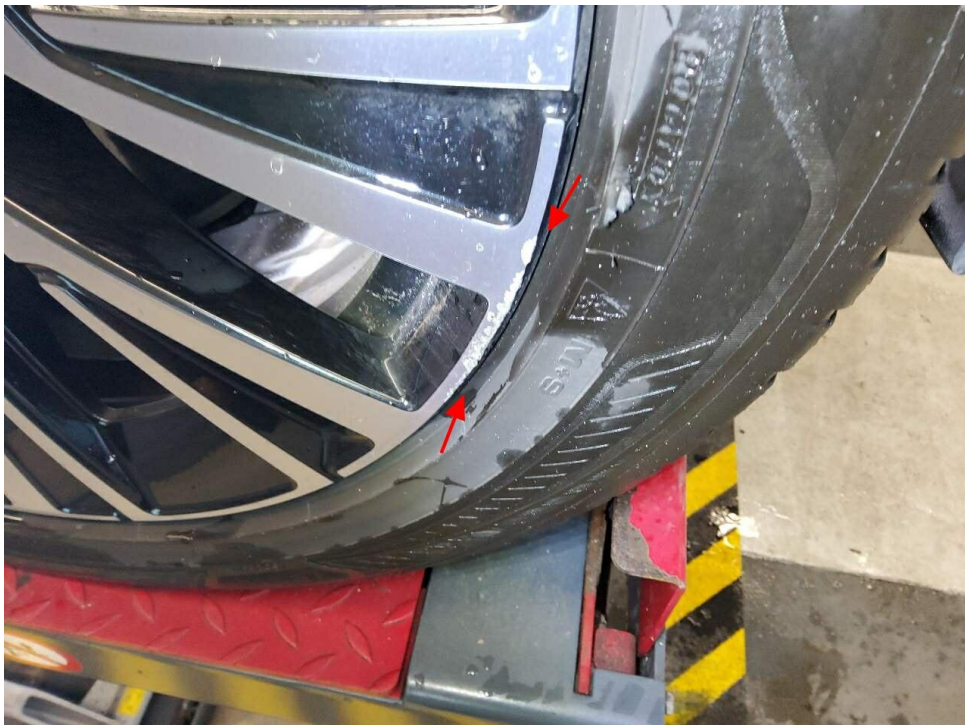
Bild 22 : Felge vorne rechts (glanzgedreht), verschrammt mit Materialabtrag
