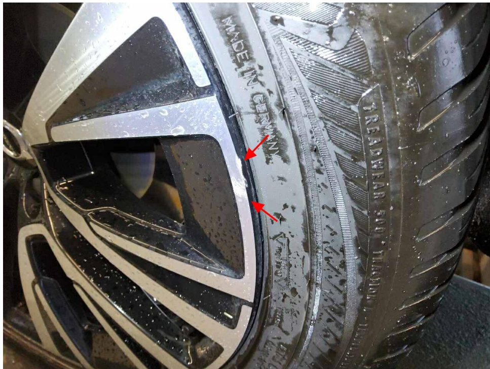
Bild 17 : Felge hinten links (glanzgedreht), verschrammt mit Materialabtrag
