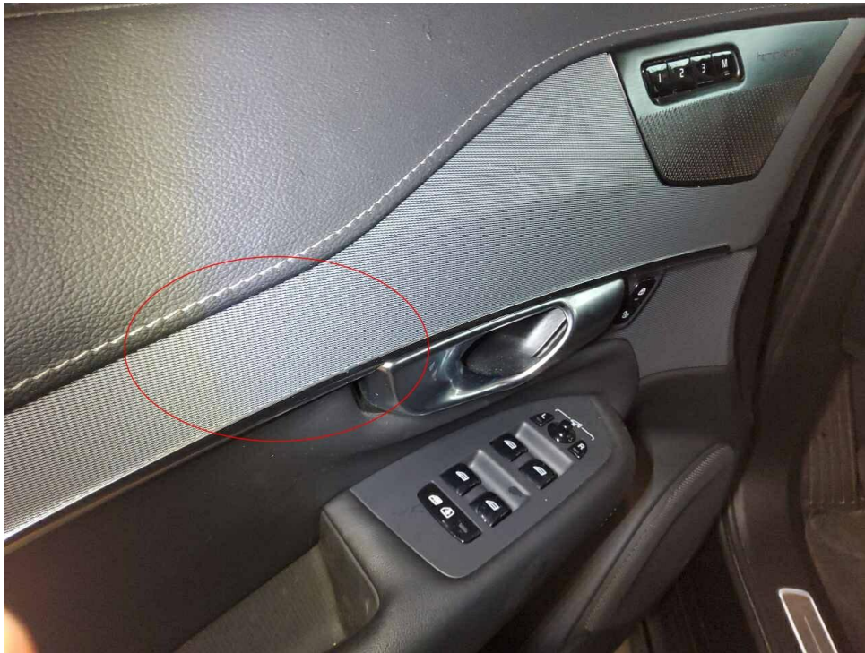
Bild 31 : Innenraum, Türverleidung vorne links, Zierleiste zerkratzt
