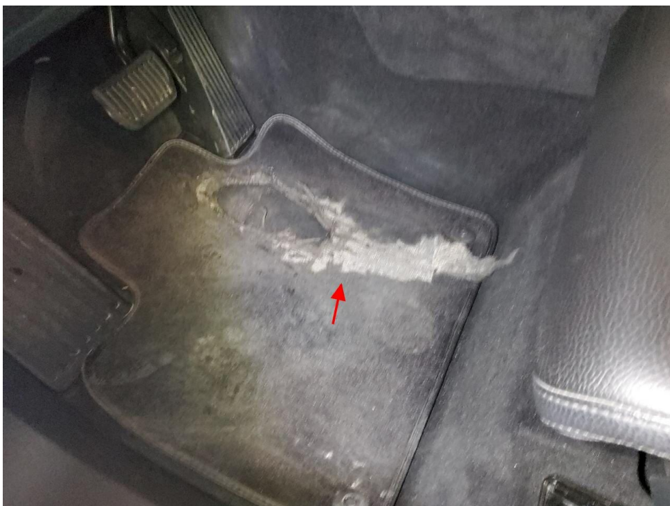
Bild 30 : Innenraum, Fahrerfußmatte verschlissen
