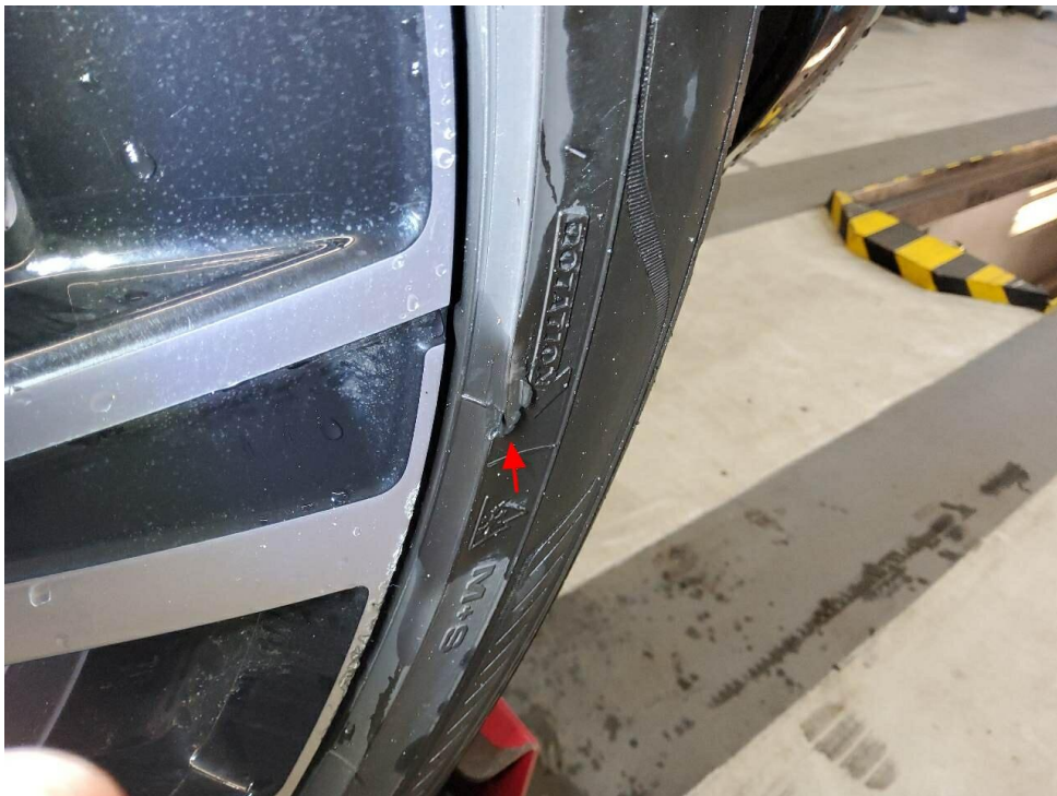
Bild 24 : Reifenflanke vorne rechts, leicht verschrammt
