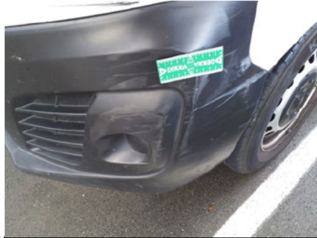
Bas de pare-chocs / Avant / Enfoncement
