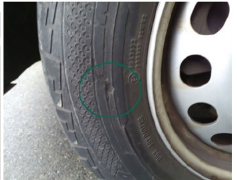
Pneu / Arrière Droit / Déchiré
