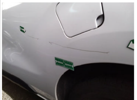
Panneau latéral / Arrière Gauche / Enfoncement
