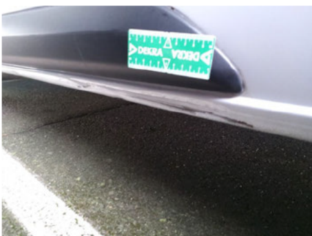
Panneau latéral / Arrière Gauche / Enfoncement
