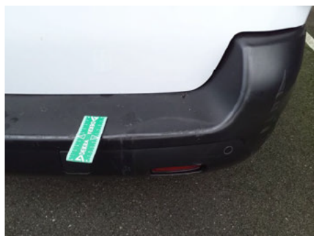
Pare-chocs / Arrière / Enfoncement
