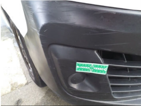
Bas de pare-chocs / Avant / Enfoncement
