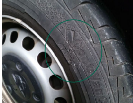
Pneu / Arrière Gauche / Déchiré
