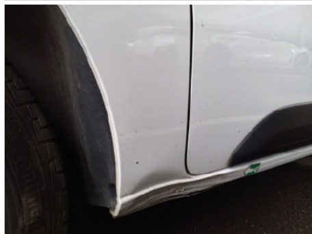
Panneau latéral / Arrière Droit / Enfoncement
