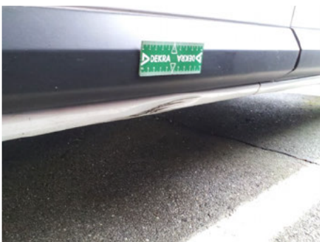
Bas de caisse / Avant Gauche / Enfoncement
