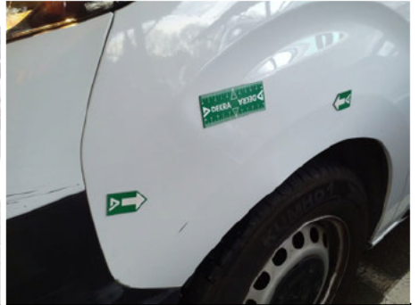
Aile / Avant Gauche / Enfoncement
