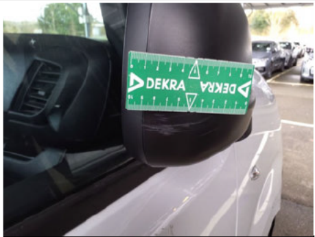
Coquille de rétroviseur / Droit / Rayure
