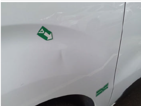
Panneau latéral / Arrière Droit / Enfoncement
