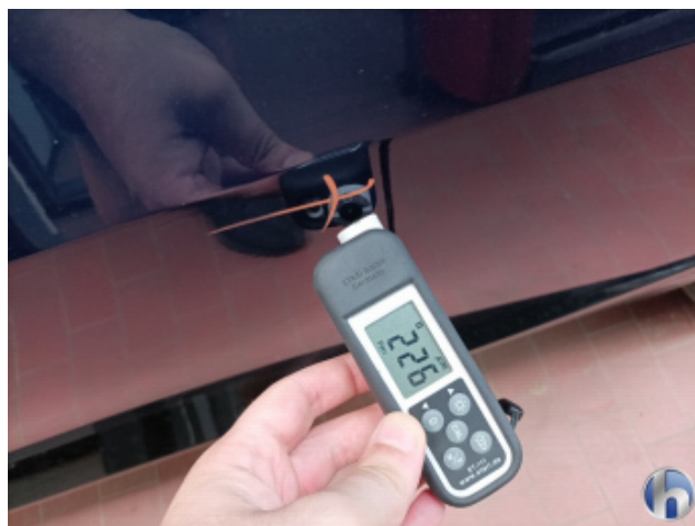
2. Tür Hinten - Links Nachlackiert - Ohne Reparatur
