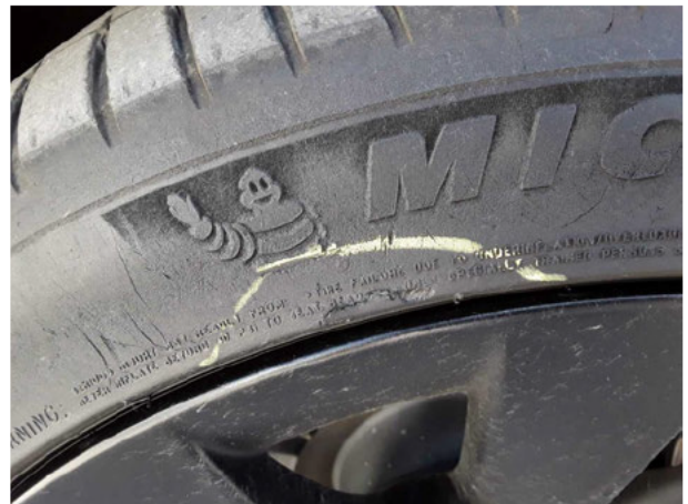
Beschädigung #4: Rad/Reifen: Reifen vorn links - beschädigt - erneuern
