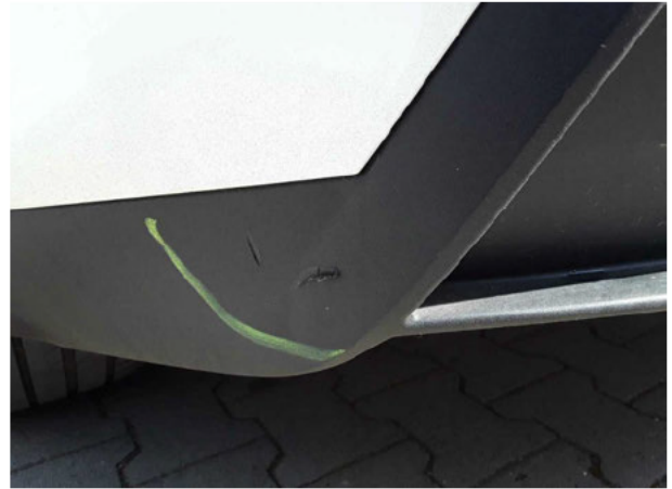
Beschädigung #6: Stossfänger hinten: Spoiler - verkratzt / verschürft - erneuern
