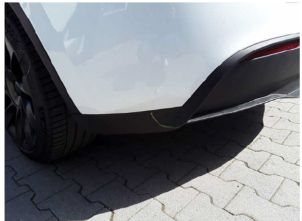
Beschädigung #6: Stossfänger hinten: Spoiler - verkratzt / verschürft - erneuern
