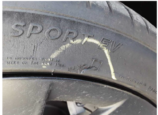
Beschädigung #4: Rad/Reifen: Reifen vorn links - beschädigt - erneuern
