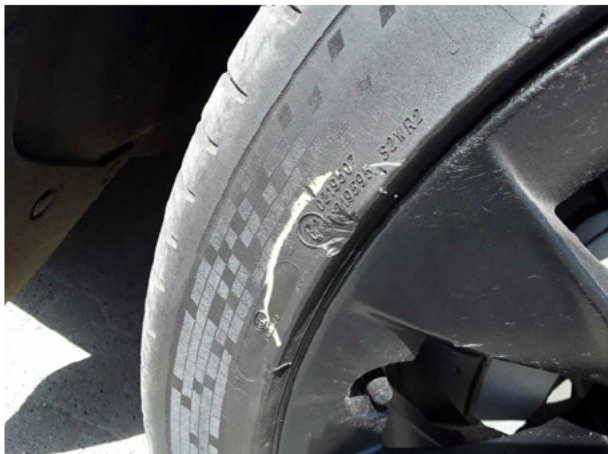
Beschädigung #5: Rad/Reifen: Reifen vorn rechts - beschädigt - erneuern
