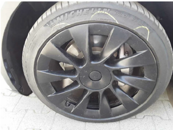
Beschädigung #4: Rad/Reifen: Reifen vorn links - beschädigt - erneuern
