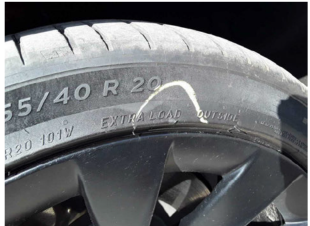
Beschädigung #5: Rad/Reifen: Reifen vorn rechts - beschädigt - erneuern
