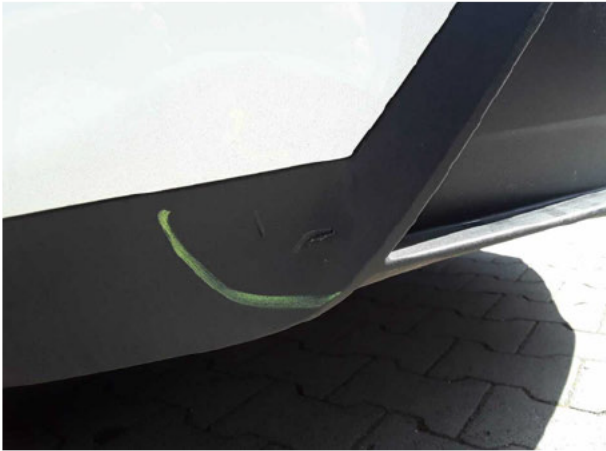
Beschädigung #6: Stossfänger hinten: Spoiler - verkratzt / verschürft - erneuern
