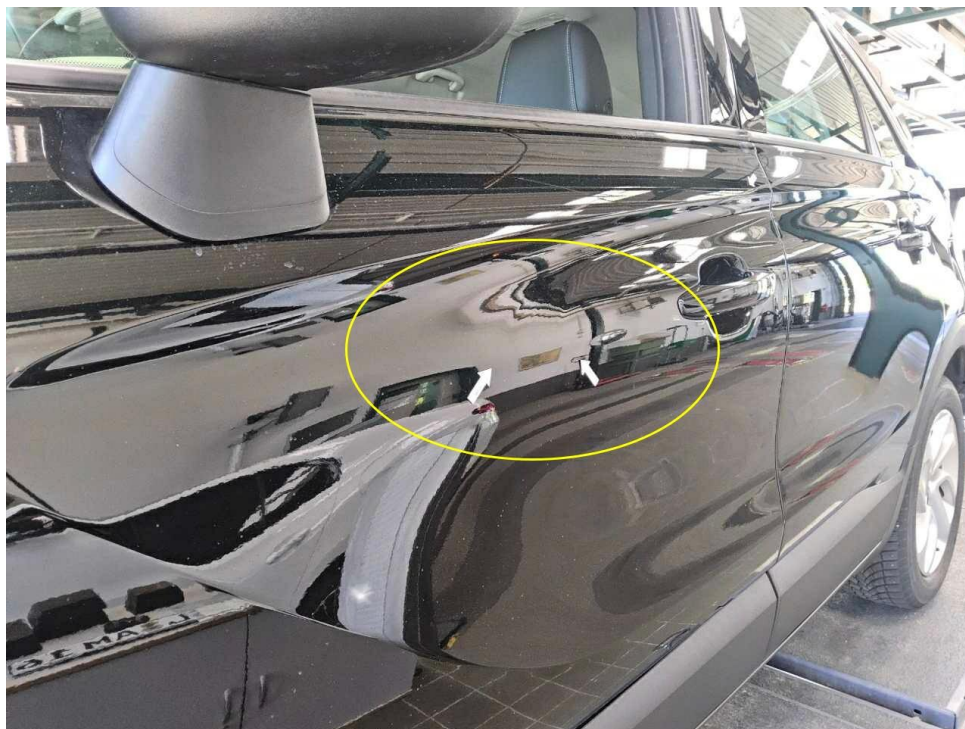
Bild 27 : Tür vorne links, eingedellt, drücken
