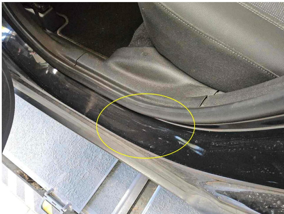
Bild 31 : Einstieg hinten links, verschrammt
