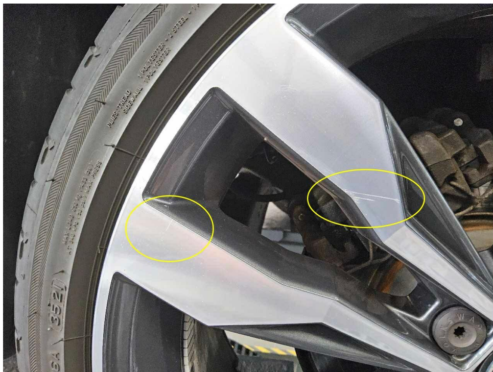
Bild 17 : Glanzgedrehte Felge hinten links, verschrammt
