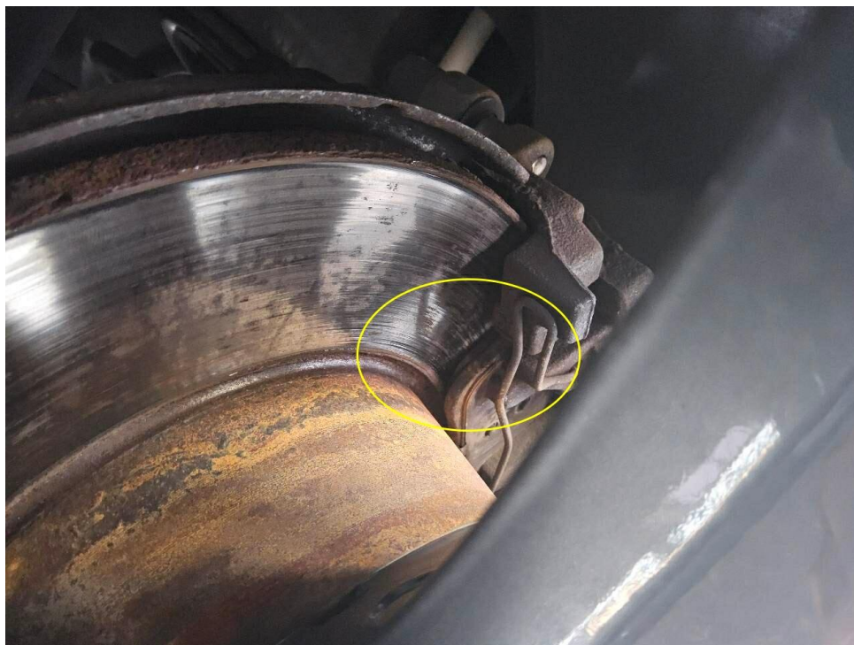
Bild 19 : Hinterachse, Bremsbeläge kurz vor Verschleißgrenze
