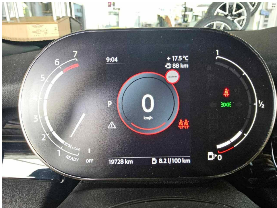
Bild 6 : Kombiinstrument (betriebsbereit) mit Km-Stand
