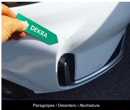
Paragolpes / Delantero / Abolladura
