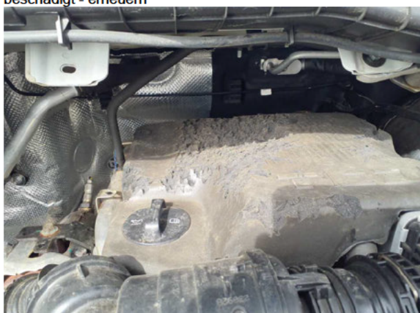
Beschädigung #2: Motor: Motorabdeckung - Marderschaden - erneuern
