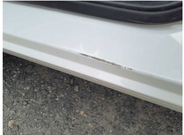
Beschädigung #5: Schweller links: Einstieg - verkratzt / verschürft - Smart Repair
