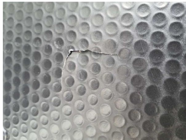
Beschädigung #1: Heckklappe/-tür: Hecktür rechts (Verkleidung) - beschädigt - erneuern
