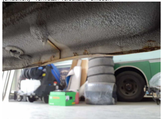
Beschädigung #7: Schweller rechts: Schweller - verformt - instandsetzen
