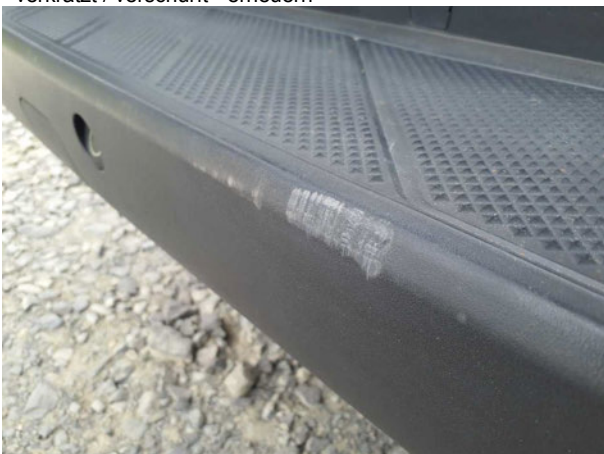
Beschädigung #6: Stossfänger hinten: Stossfänger hinten (unlackiert) - verkratzt / verschürft - erneuern
