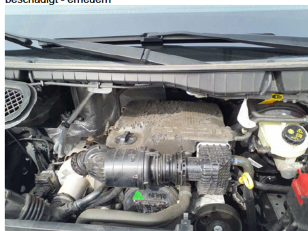
Beschädigung #2: Motor: Motorabdeckung - Marderschaden - erneuern
