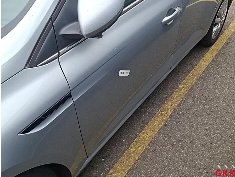
Bild 19. Tür vorne links, verkratzt, lackieren
