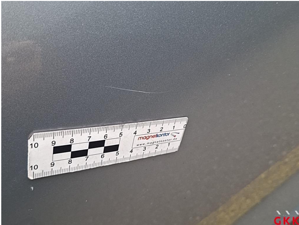
Bild 20. Tür vorne links, verkratzt, lackieren
