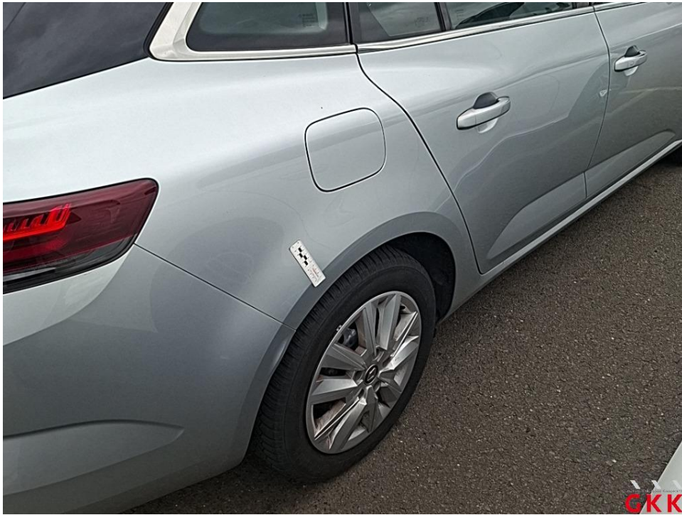
Bild 23. Seitenwand rechts, verkratzt, lackieren
