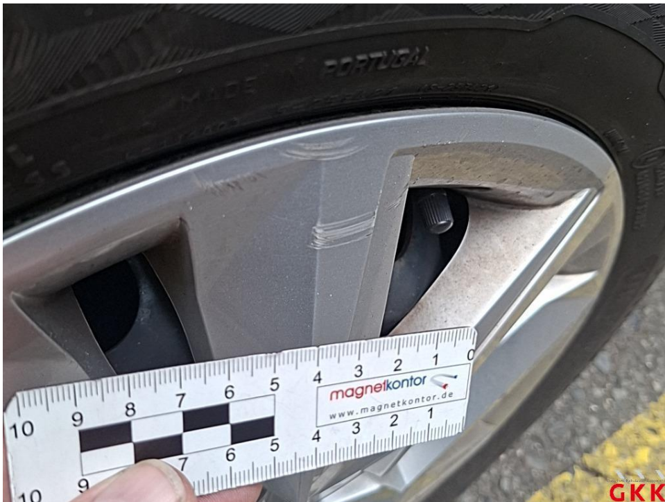
Bild 18. Radkappe(n), vorne links, beschädigt, ersetzen
