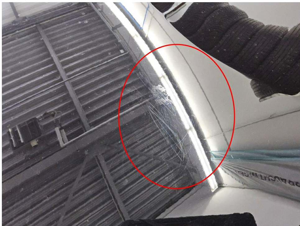
Bild 14 : Motorhaube zerkratzt und Umweltschaden
