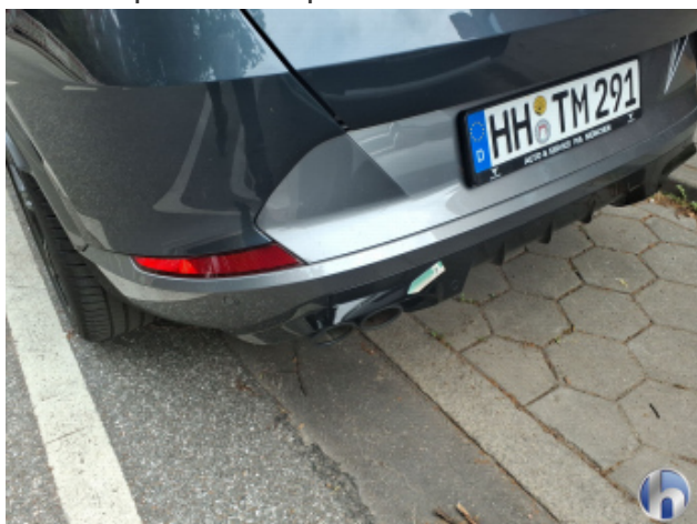
3. Stoßfänger Hinten Abschürfung - Smart Repair
