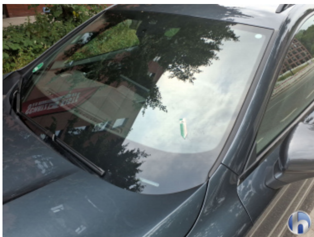
5. Windschutzscheibe Gebrauchsspuren - Ohne Reparatur
