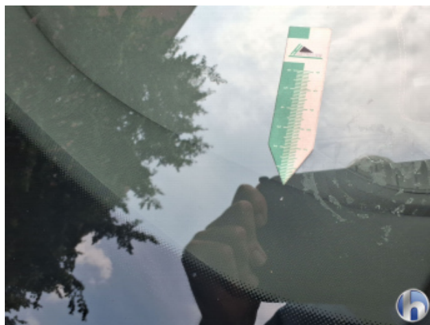
5. Windschutzscheibe Gebrauchsspuren - Ohne Reparatur
