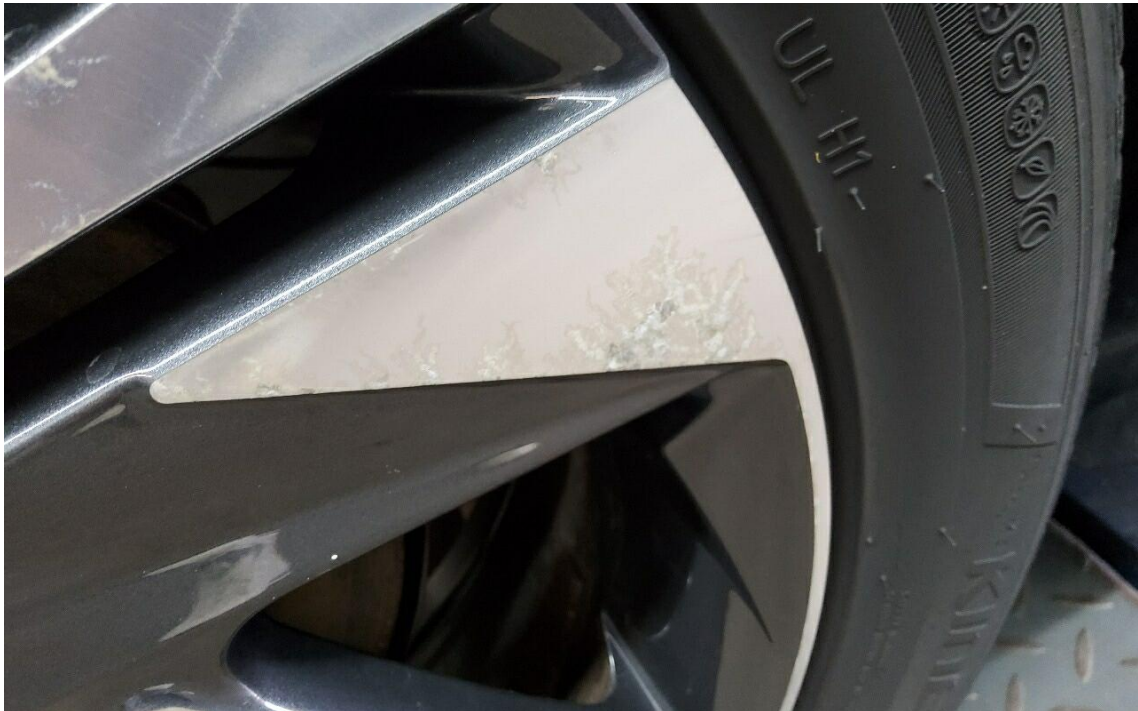
Bild 11 : Felge hinten rechts, Oberflächenkorrosion
