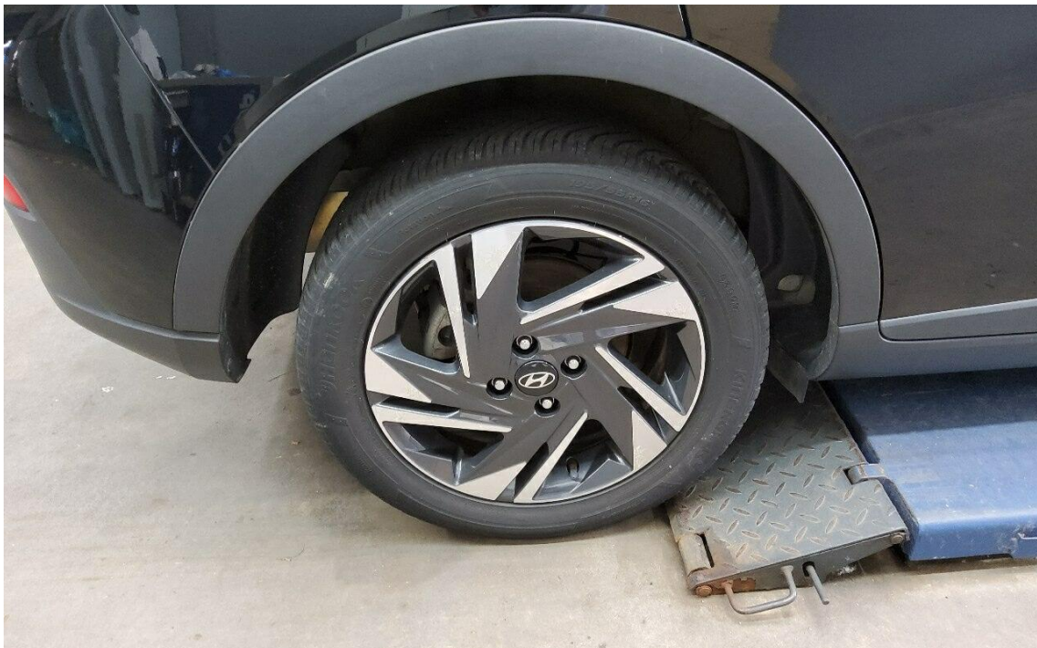
Bild 10 : Felge hinten rechts, Oberflächenkorrosion
