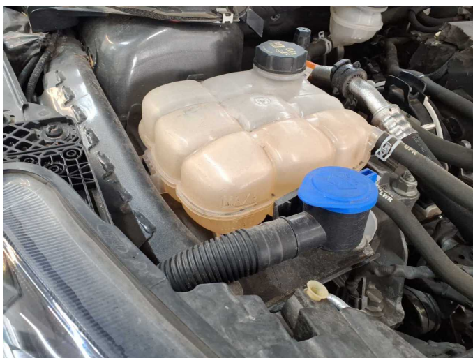
Damage 3: Engine cooling: Coolant (Behälter - Mehrkosten möglich) - Leaking - Perform diagnosis
