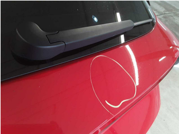
Beschädigung #2: Heckklappe/-tür: Heckklappe - Delle(n) - sanft instandsetzen
