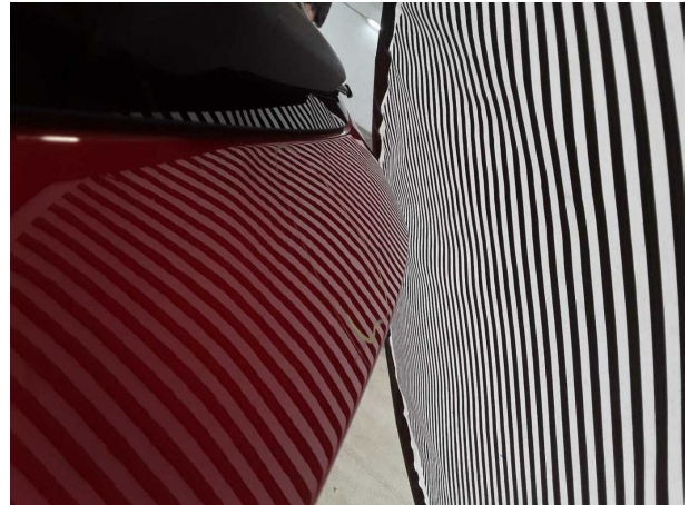
Beschädigung #2: Heckklappe/-tür: Heckklappe - Delle(n) - sanft instandsetzen
