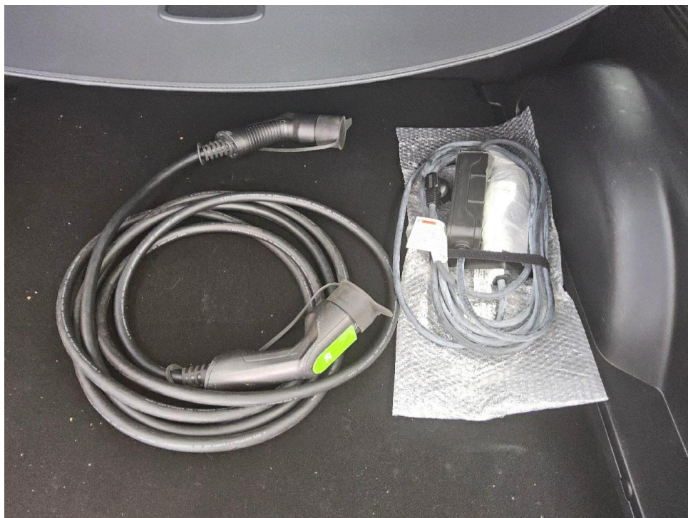
Bild 6 : Ladekabel beim E-Fahrzeug
