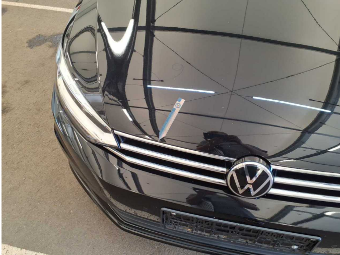
Damage 4: Bonnet: Bonnet (Korrosion durch Steinschlag) - Stone chips - Repair and paint
