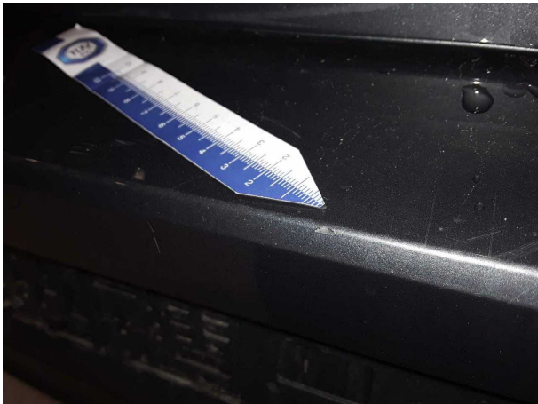
Beschädigung #3: Stossfänger hinten: Stossfänger hinten - verkratzt / verschürft - lackieren
