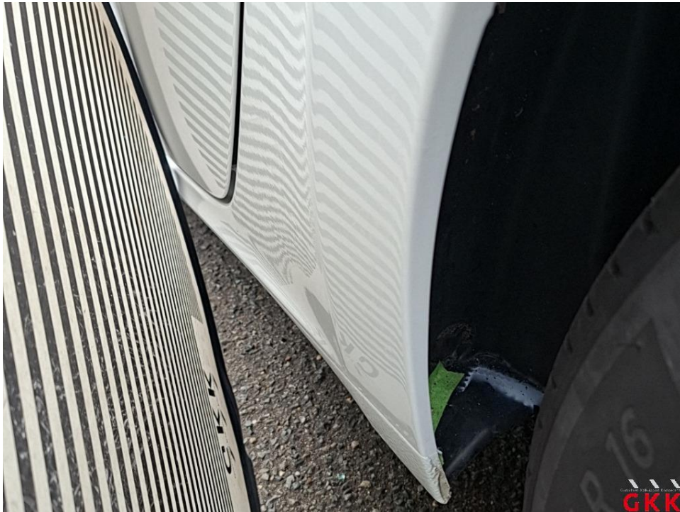
Bild 16. Seitenwand links, Reparaturmangel, lackieren
