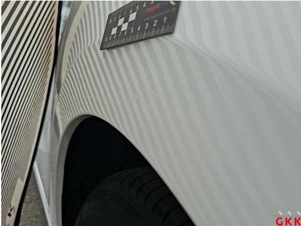
Bild 15. Seitenwand links, Reparaturmangel, lackieren
