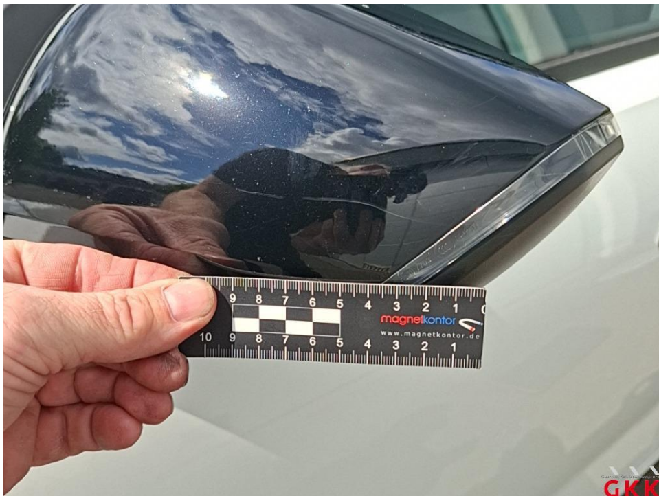
Bild 34. Spiegelgehäuse links, Kappe -lackiert-, verkratzt, Smartrepair
