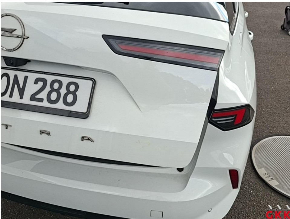
Bild 40. Heckklappe, Blende -lackiert-, beschädigt, Smartrepair
