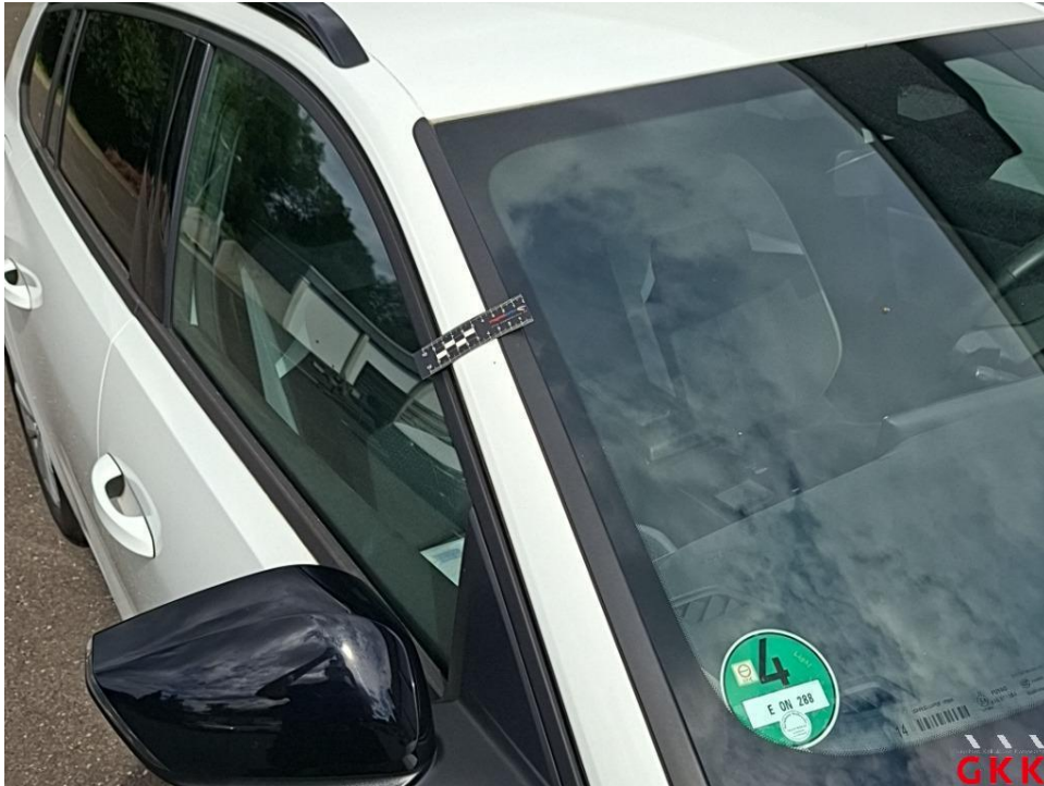
Bild 17. A- Säule rechts, Steinschlag, Smartrepair
