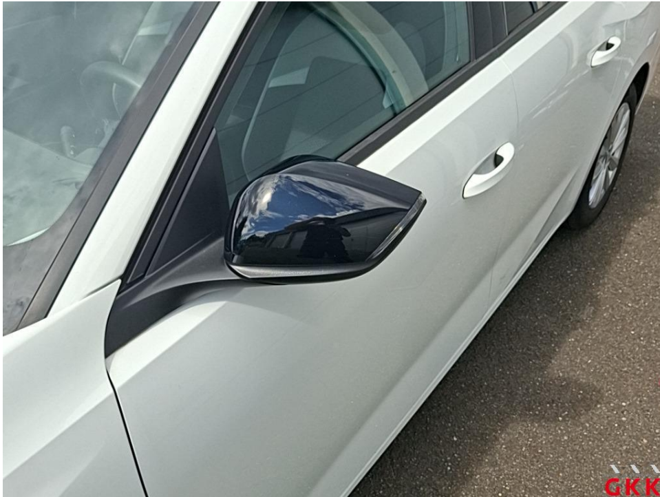
Bild 33. Spiegelgehäuse links, Kappe -lackiert-, verkratzt, Smartrepair
