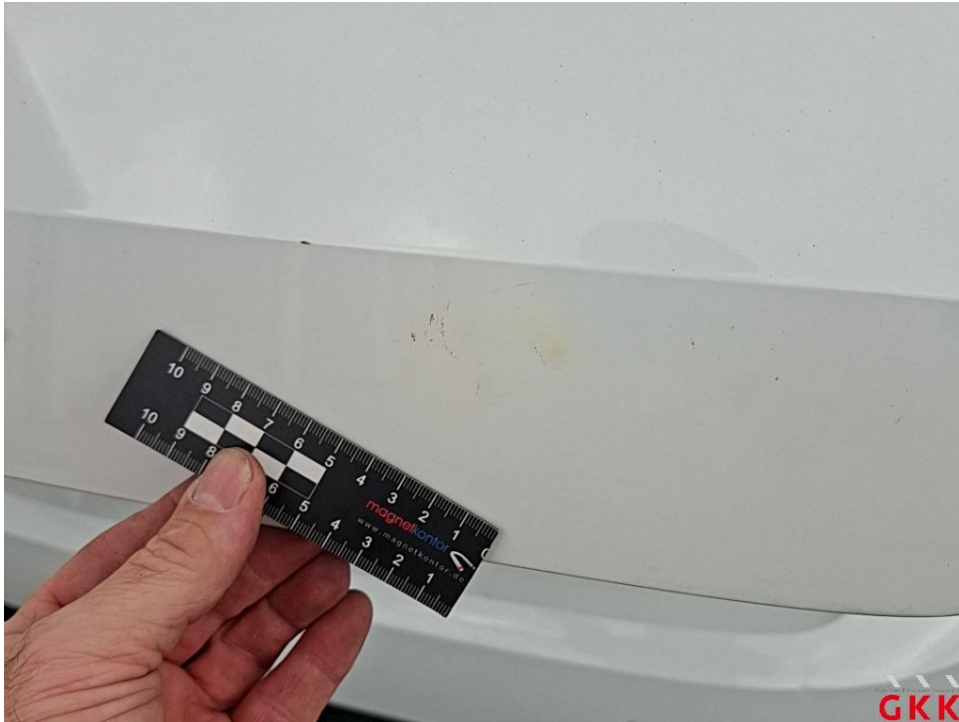
Bild 41. Heckklappe, Blende -lackiert-, beschädigt, Smartrepair
