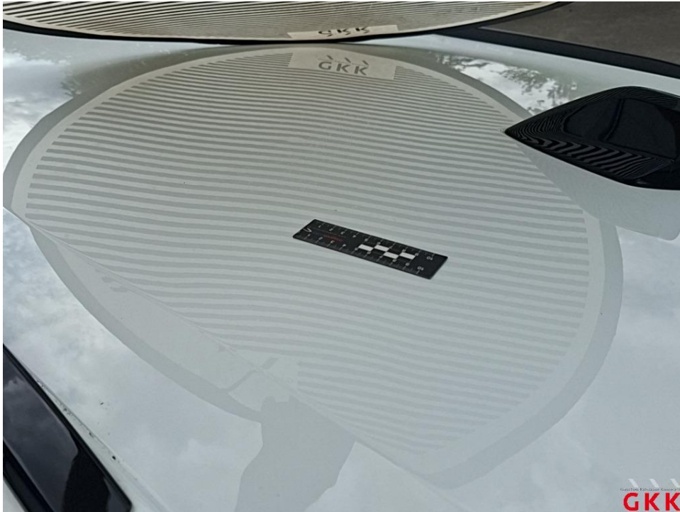
Bild 23. Dach, bis 3 Dellen / Bauteil, kalt drücken
