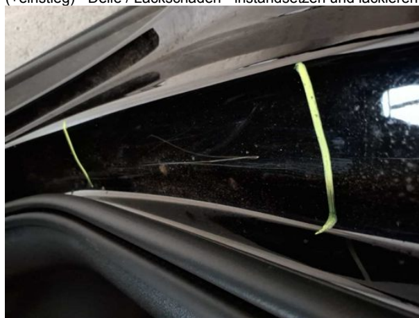
Beschädigung #16: Seitenwand rechts: Seitenwand (+einstieg) - Delle / Lackschaden - instandsetzen und lackieren
