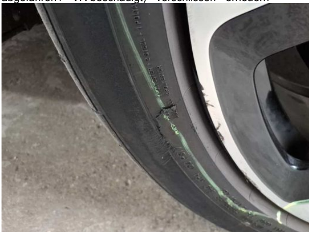
Beschädigung #15: Rad/Reifen: Reifen vorn (Reifen außen abgefahren / +VR beschädigt) - verschlissen - erneuern
