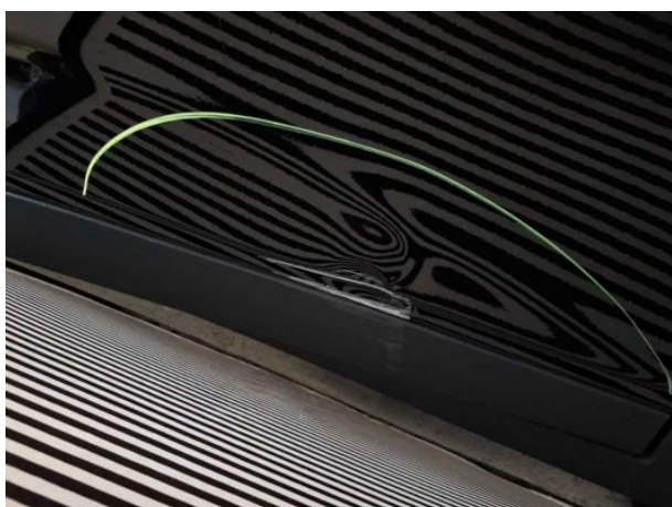
Beschädigung #18: Tür hinten links: Tür - beschädigt - erneuern
