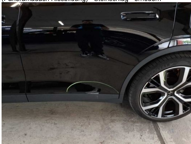
Beschädigung #18: Tür hinten links: Tür - beschädigt - erneuern
