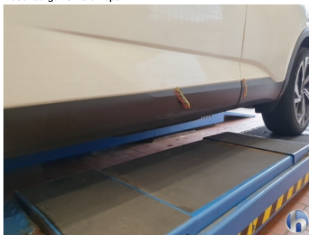
6. Türleisten Vorne & Hinten - Links Beschädigt - Erneuern
