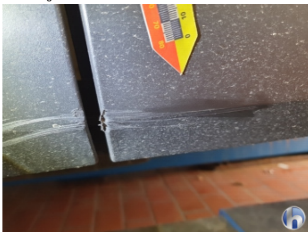
6. Türleisten Vorne & Hinten - Links Beschädigt - Erneuern
