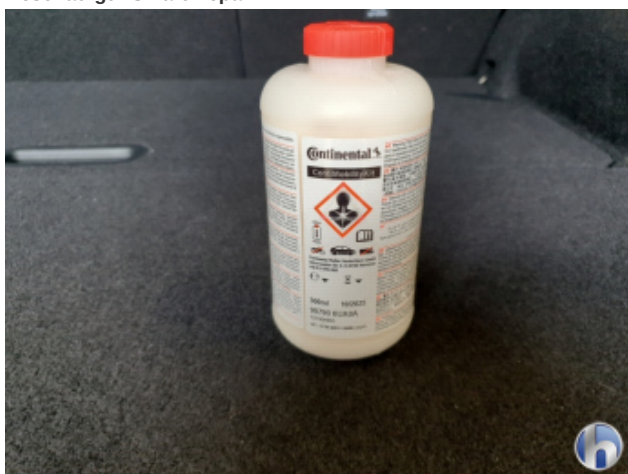
5. Tire-fit Füllmittel Fällig - Erneuern
