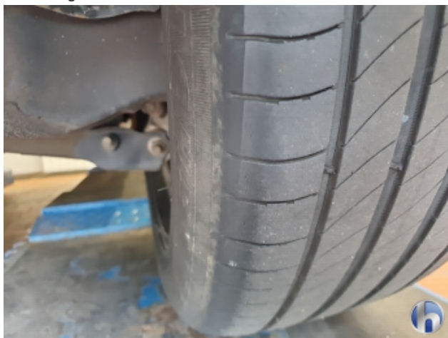
8. Hinterreifen Nicht Verkehrssicher - Ohne Reparatur
