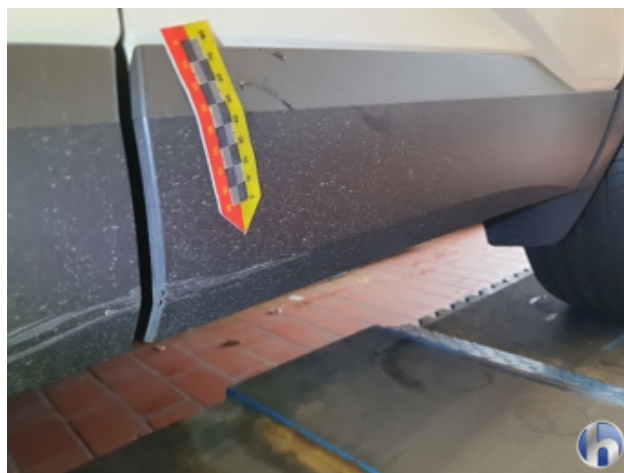
6. Türleisten Vorne & Hinten - Links Beschädigt - Erneuern
