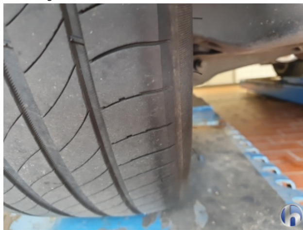
8. Hinterreifen Nicht Verkehrssicher - Ohne Reparatur
