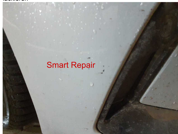
Beschädigung #2: Stossfänger vorn: Stossfänger vorn - verkratzt / verschürft - Smart Repair
