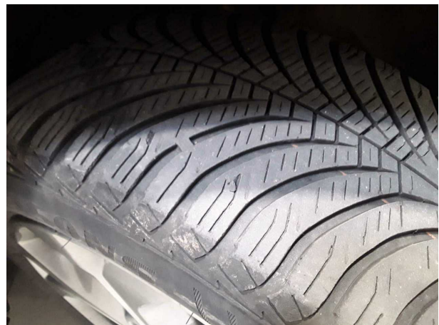
Beschädigung #2: Rad/Reifen: Reifen vorn (2 x Ganzjahresreifen vorne unter 4 mm Profiltiefe) - entspricht nic...
