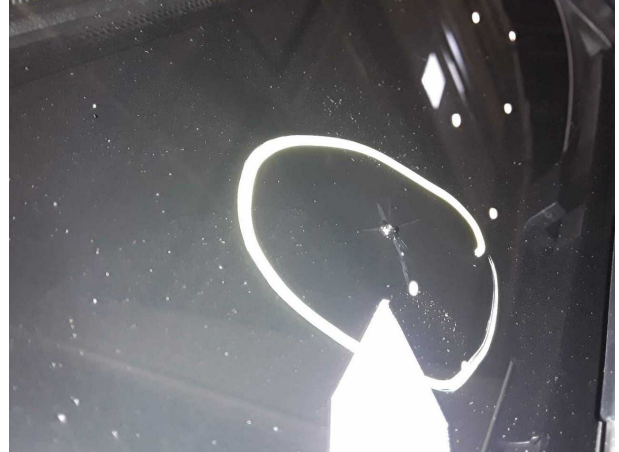
Beschädigung #3: Verglasung: Frontscheibe - Steinschlag - erneuern
