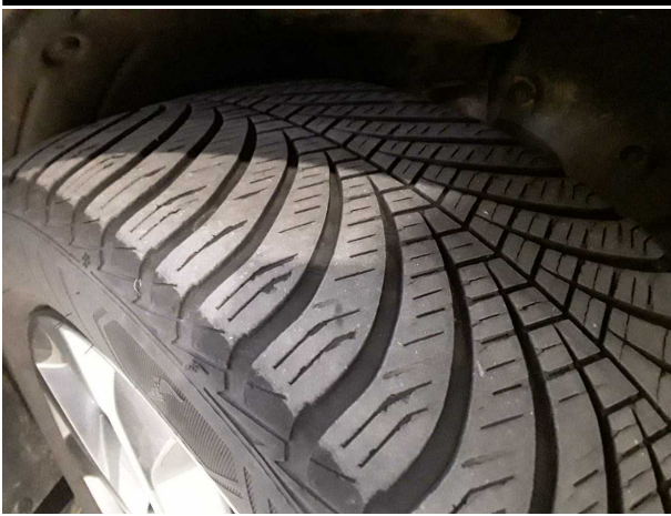
Beschädigung #2: Rad/Reifen: Reifen vorn (2 x Ganzjahresreifen vorne unter 4 mm Profiltiefe) - entspricht nicht den Leasingvorgab...
